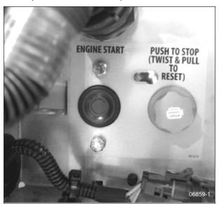
TYPICAL ENGINE STOP/ IGNITION INTERLOCK BUTTON
