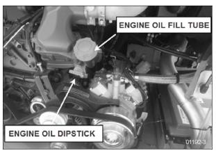
**ENGINE OIL DIPSTICK - VOLVO D13 ENGINE**
