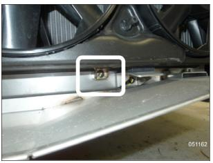
**FAN SHROUD TOP & BOTTOM HOLD-DOWN SCREWS**
