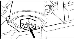
FIGURE 19: OIL FILTER HOUSING DRAIN PLUG
