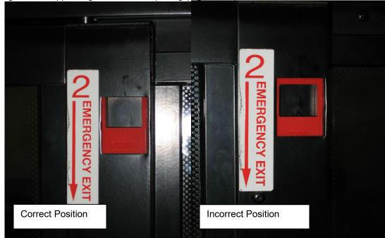
FIGURE 111: RELEASE LATCH PROPER POSITION
