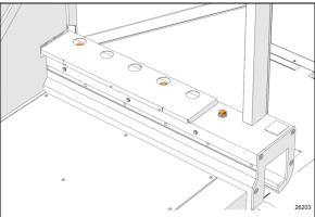
FIGURE 46: TOP RAIL SCREWS
