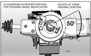
FIGURE 15: PROPER CLOCKSPRING POSITION
