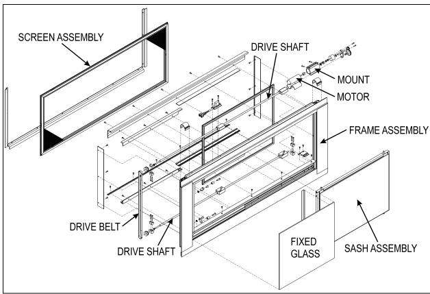
FIGURE 106: ELECTRIC SLIDING WINDOW EXPLODED VIEW
