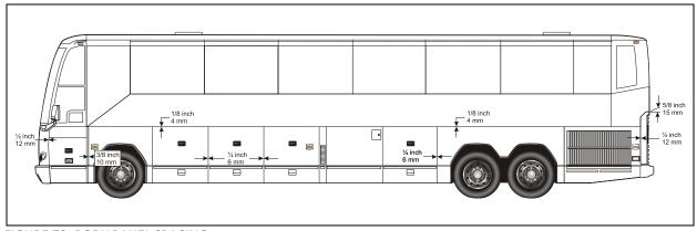
FIGURE 72: BODY PANEL SPACING
