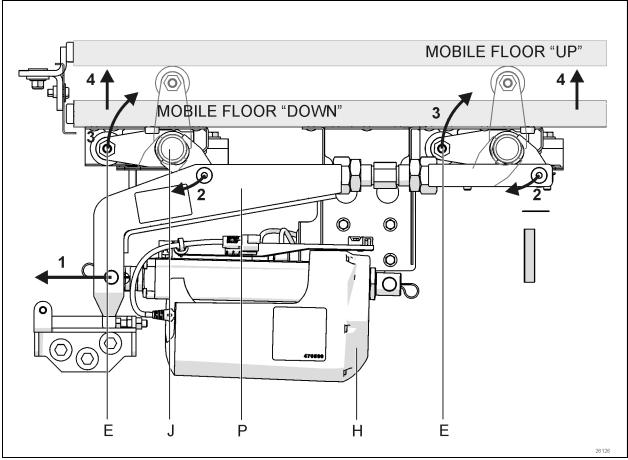
FIGURE 58: FLUSH FLOOR LIFTING
