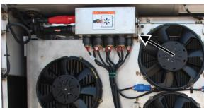
FIGURE 4: ELECTRIC COOLING FAN CIRCUIT BREAKER BOX
