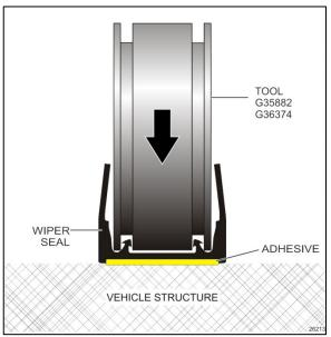
FIGURE 5: ROLLER TOOL (BASE WIPER SEAL)
