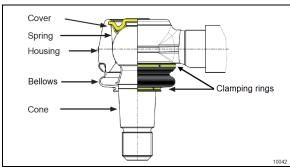
FIGURE 35 TIE ROD BALL JOINT
