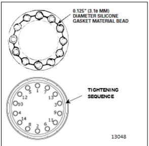
FIGURE 40: AXLE FLANGE TIGHTENING SEQUENCE
