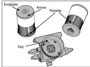
FIGURE 9: KEYWAY ON FUEL PRO 386 FILTER ONLY
