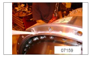
FIGURE 12: SILICONE APPLICATION TRANSMISSION HOUSING
