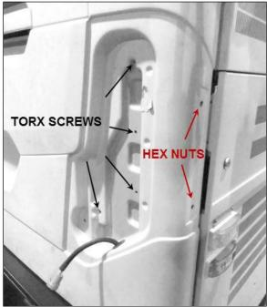
FIGURE 108: TAILLAMP POD RETAINING SCREWS & NUTS
