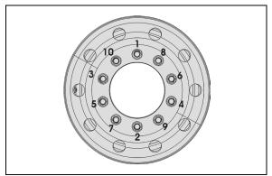
FIGURE 3: TIGHTENING SEQUENCE
