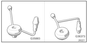
FIGURE 4: INFLATABLE SEAL ROLLER TOOLS
