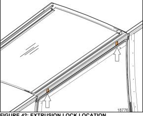
FIGURE 42: EXTRUSION LOCK LOCATION
