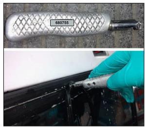
FIGURE 67: LOCKING STRIP INSERTION TOOL 680755
