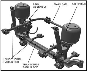
FIGURE 1: FRONT I-BEAM AXLE SUSPENSION 16105
