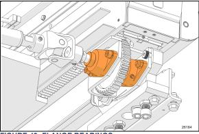
FIGURE 43: FLANGE BEARINGS
