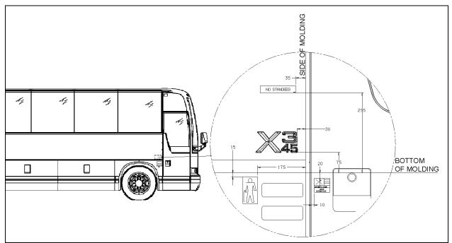
FIGURE 85: SIDE CREST POSITIONING
