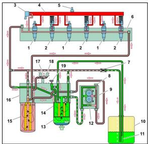
FIGURE 1: FUEL SYSTEM SCHEMATIC (VOLVO D13 ENGINE)
