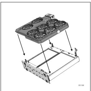
FIGURE 54: FAN SHROUD POSITIONING
