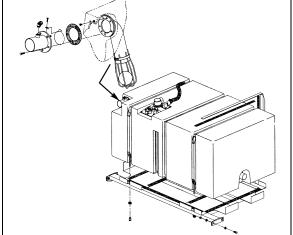
FIGURE 15: 208 US GALLONS FUEL TANK
