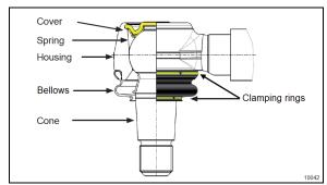
FIGURE 38: TIE ROD BALL JOINT CONSTRUCTION
