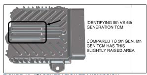
FIGURE 15: 6<sup>TH</sup> GENERATION TRANSMISSION CONTROL MODULE (07140)
