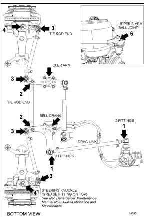
FIGURE 31: LUBRICATION FITTINGS LOCATION
