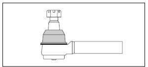
FIGURE 39: STRAIGHT BODY TYPE BALL JOINT
