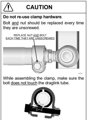
FIGURE 32: I-BEAM FRONT AXLE DRAG LINK
