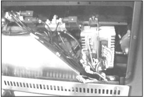
FIGURE 30: ENTRANCE DOOR & WIPER CONTROL PANEL 06619
