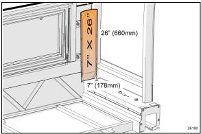
FIGURE 55: REAR LEFT SLIDE-OUT "NO DRILLING ZONE"
