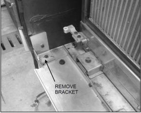
FIGURE 49: RADIATOR DOOR LOWER HINGE BRACKET
