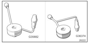
FIGURE 3: BASE WIPER SEAL ROLLER TOOLS
