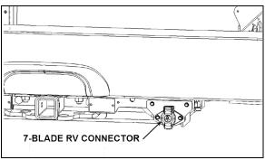
FIGURE 44: 7-BLADE TRAILER/RV CONNECTOR ON TRAILER HITCH
