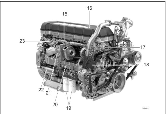
FIGURE 4: D13N ENGINE OVERVIEW, ROAD SIDE A.K.A HOT SIDE
