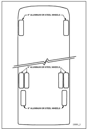
FIGURE 1: ALUM/STEEL WHEEL ARRANGEMENT
