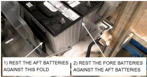
FIGURE 55: PROPER POSITIONING OF THE BATTERIES
