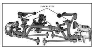
FIGURE 5: IFS TYPICAL DATA PLATE LOCATION 16136
