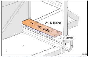
FIGURE 54: FRONT LEFT SLIDE-OUT "NO DRILLING" ZONE
