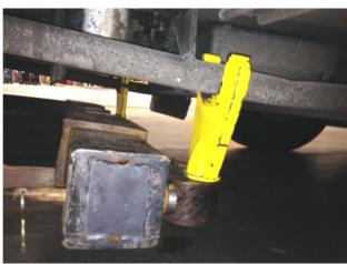
FIGURE 61: PROPER LOCATION WHEN LIFTING THE SIDE MEMBERS
