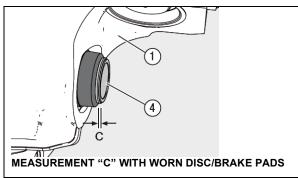
FIGURE 33: BRAKE PAD WEAR CHECK ON THE DRIVE AXLE
