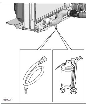
FIGURE 18: EXTRACTING COOLANT
