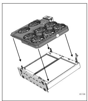
FIGURE 38: FAN SHROUD POSITIONING
