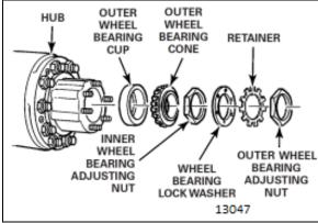
FIGURE 39: DRIVE AXLE WHEEL HUB
