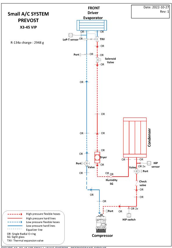
FIGURE 12: X3-45 VIP SMALL HVAC SYSTEM - REFRIGERANT CIRCUIT
