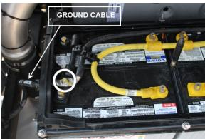
FIGURE 48: DISCONNECT GROUND CABLE FIRST
