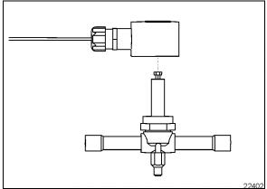
FIGURE 70: TYPICAL REFRIGERANT SOLENOID VALVE
