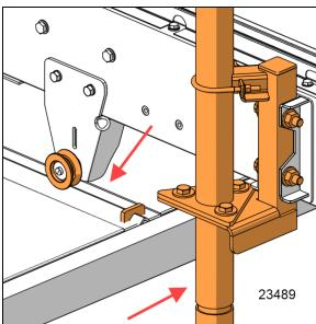
FIGURE 62: DROP THE REAR SIDE ON RAILS
