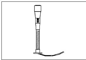
FIGURE 11: BOOM-TYPE MICROPHONE
