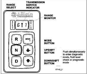
FIGURE 2: ALLISON PUSHBUTTON SHIFT SELECTOR
