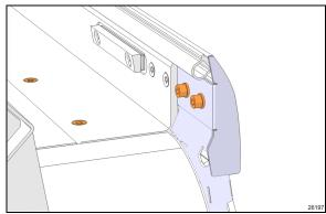
FIGURE 18: EXTRUSION END CAP
