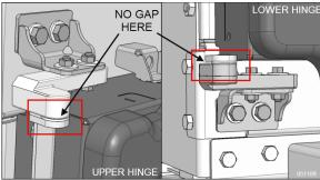
FIGURE 39: SHROUD HINGES INSTALLATION
