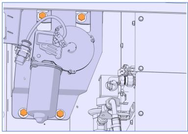
Figure 15: CURBSIDE DRIVE MOTOR
