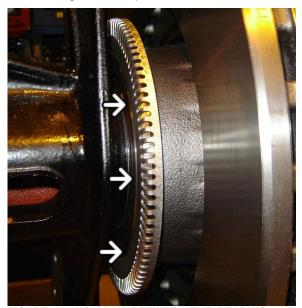
FIGURE 22: NO PLAY BETWEEN THE BEARING AND THE SPINDLE SHOULDER
