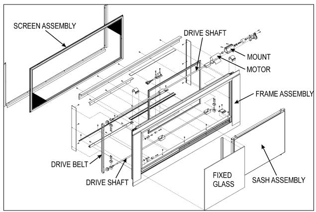
FIGURE 46: ELECTRIC SLIDING WINDOW EXPLODED VIEW
