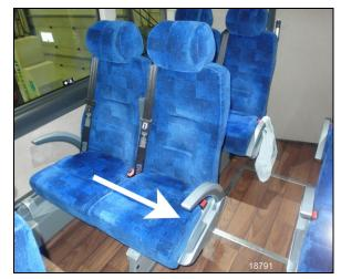
FIGURE 88: PULL TO UNLOCK THE ROTATION
