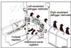
FIGURE 82: DRIVER UNIT AIR CIRCULATION
