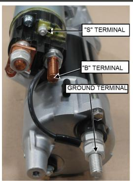
FIGURE 4: TERMINAL IDENTIFICATION
