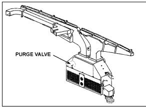
FIGURE 89: DRIVER UNIT AIR MIXING BOX 2
