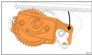
FIGURE 37: PINION ASSEMBLY ROTATION
