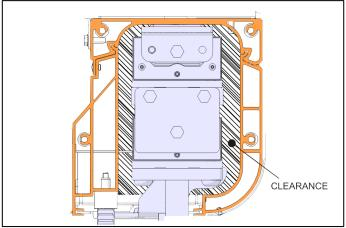
FIGURE 9: CLEARANCE AROUND THE RAIL, END VIEW
