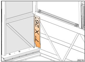
FIGURE 53: FRONT LEFT SLIDE-OUT "NO DRILLING" ZONE
