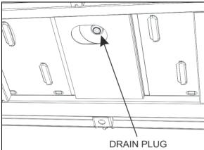
FIGURE 19: FUEL TANK DRAIN PLUG
