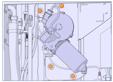
Figure 16: STREET SIDE DRIVE MOTOR
