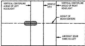
FIGURE 103: UPPER BEAM HIGH-INTENSITY ZONE
