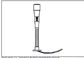
FIGURE 11: BOOM-TYPE MICROPHONE
