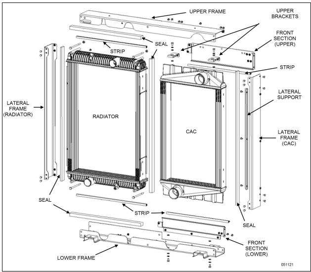
FIGURE 60: COOLING PACK EXPLODED VIEW
