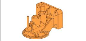
FIGURE 4: COOLANT FILTER HOUSING
