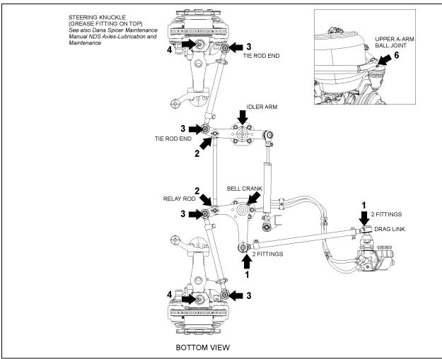
FIGURE 20: LUBRICATION FITTINGS LOCATION 1604
