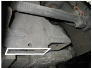
FIGURE 3 : CHASSIS HOISTING POINTS
