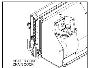
FIGURE 94: HEATER CORE DRAIN COCK LOCATION
