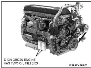
FIGURE 7: D13N FROM OBD20 OIL FILTER CONFIGURATION
