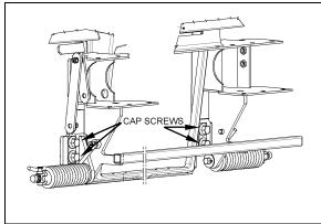
FIGURE 10: FRONT BUMPER ASSEMBLY
