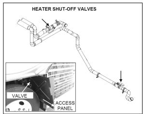
FIGURE 43: HEATER SHUT-OFF VALVES POSITION
