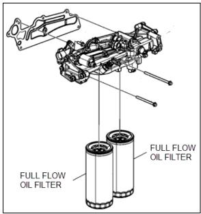
FIGURE 9: D13N OBD23 OIL FILTERS
