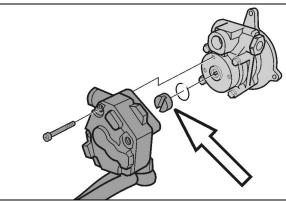
FIGURE 13: FUEL PUMP DRIVE AXLE
