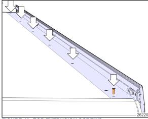
FIGURE 19: TOP EXTRUSION SCREWS
