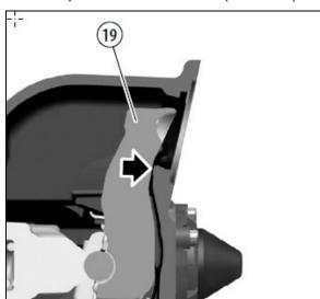
FIGURE 43: CHECK LEVER POSITION
