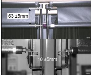
FIGURE 20: FACTORY ADJUSTMENT OF UPPER AND LOWER END POSITION
