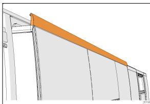
FIGURE 18 TOP EXTRUSION
