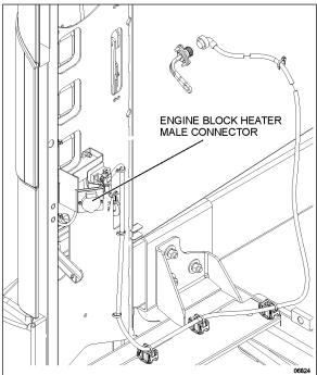
FIGURE 70: ENGINE BLOCK HEATER CONNECTION
