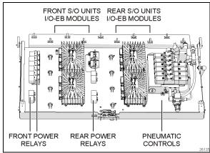
FIGURE 49: SLIDE-OUT CONTROL PANEL
