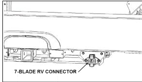
FIGURE 34: 7-BLADE TRAILER/RV CONNECTOR ON TRAILER HITCH
