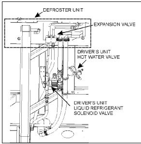
FIGURE 68: DRIVER UNIT LIQUID SOLENOID VALVE
