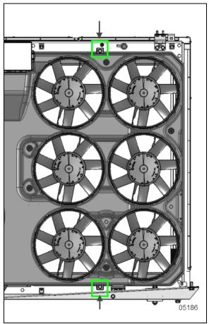
FIGURE 25: SHROUD HOLD DOWN SCREWS
