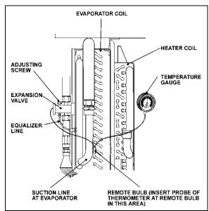
FIGURE 72: SUPERHEAT ADJUST. INSTALLATION
