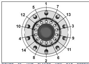
FIGURE 38: HUB FLANGE HEX CAP SCREW TIGHTENING SEQUENCE
