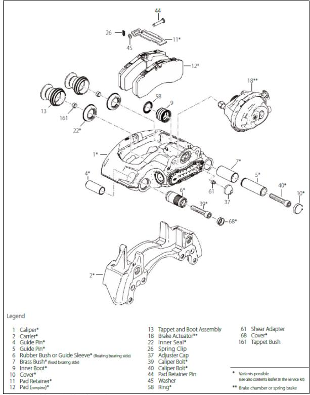
FIGURE 23: DISC BRAKE COMPONENTS
