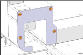
FIGURE 7: EXTRUSION END CAP
