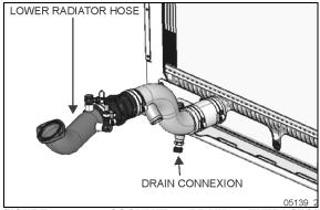
FIGURE 44: COOLANT DRAIN EXTRACTOR CONNECTION
