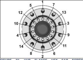
FIGURE 33: HUB FLANGE HEX CAP SCREW TIGHTENING SEQUENCE
