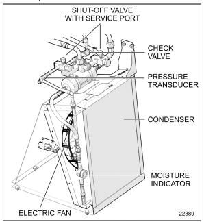
FIGURE 101: CONDENSER CONFIGURATION X3-45 VIP
