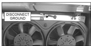
FIGURE 47: COOLING ASSEMBLY GROUND
