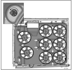
FIGURE 22: SHROUD COVER FASTENER LOCATION
