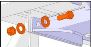
FIGURE 27: LONGITUDINAL SCREWS, 4 LOCATIONS
