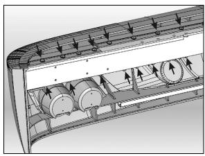
FIGURE 9: ALUMINUM EXTRUSIONS - BUMPER SKIN REMOVAL
