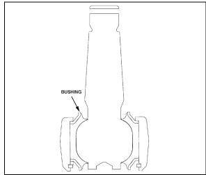
FIGURE 29: LOWER A-ARM BALL JOINT
