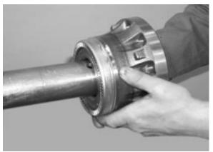
FIGURE 20: SLIP UNITIZED HUB BEARING OVER SPINDLE
