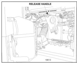
FIGURE 98: FRONT BUMPER RELEASE HANDLE
