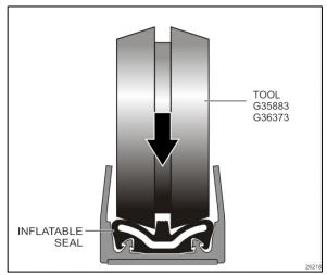
FIGURE 6: ROLLER TOOL (INFLATABLE SEAL)
