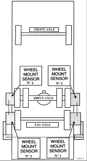
FIGURE 16: TAG AXLE ALIGNMENT
