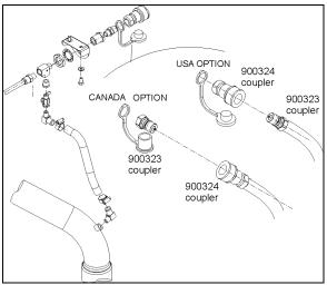
FIGURE 30: SUMP TANK FILL CONNECTION
