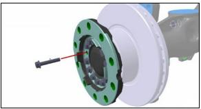
FIGURE 32: HUB FLANGE HEX CAP SCREW
