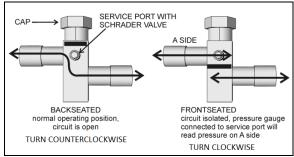
FIGURE 66: REFRIGERANT CIRCUIT SHUT-OFF VALVE
