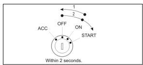
FIGURE 32: IGNITION SWITCH SEQUENCE
