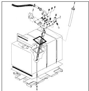
FIGURE 14: 222 US GALLONS FUEL TANK
