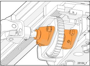
FIGURE 42: FLANGE BEARINGS
