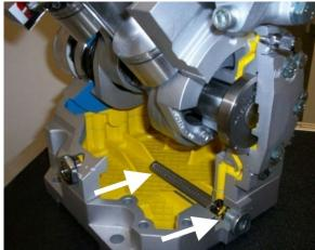
FIGURE 48: CUTAWAY VIEW SHOWING OIL FILTER/STRAINER AND MAGNETIC DRAIN PLUG
