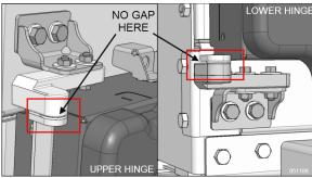
FIGURE 55: SHROUD HINGES INSTALLATION
