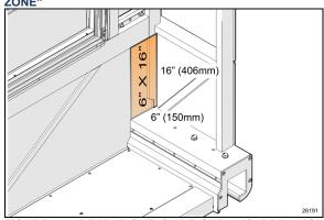
FIGURE 56: REAR RIGHT SLIDE-OUT "NO DRILLING" ZONE
