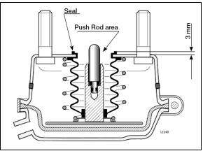
FIGURE 53: FRONT AND TAG AXLE BRAKE AIR CHAMBER
