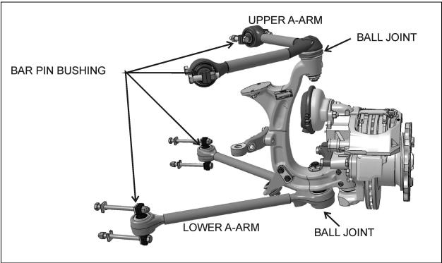
FIGURE 25: A-ARM JOINT IDENTIFICATION
