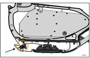
FIGURE 108:MODULES UNDER PARCEL RACK BLOWER HOUSING
