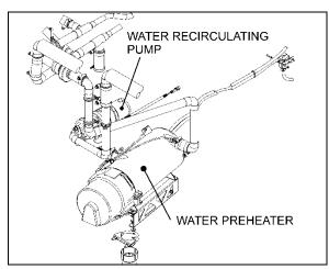
FIGURE 76: PUMP LOCATION – X3 SERIES (BIG A/C)22331
