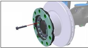
FIGURE 37: HUB FLANGE HEX CAP SCREW
