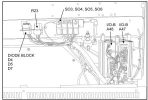
FIGURE 21: ENTRANCE DOOR & WIPER CONTROL PANEL 06619
