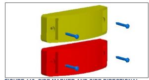
FIGURE 112: SIDE MARKER AND SIDE DIRECTIONAL LIGHTS
