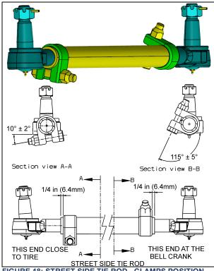
FIGURE 18: STREET SIDE TIE ROD - CLAMPS POSITION 16200
