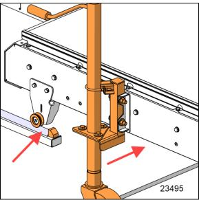
FIGURE 49: DROP THE REAR SIDE ON RAILS
