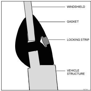
FIGURE 19: WINDSHIELD INSTALLATION SIDE VIEW
