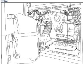
FIGURE 47: FRONT VALVE LOCATION ON X3 SERIES
