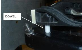
FIGURE 57: DOWEL ON ANGLE
