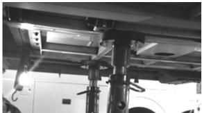
FIGURE 24: JACK STANDS UNDER THE FUEL TANK CRADLE
