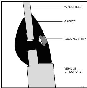
FIGURE 101: WINDSHIELD INSTALLATION SIDE VIEW
