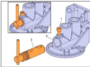
FIGURE 10: INSERTING THE SPINDLE
