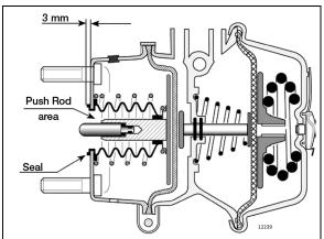
FIGURE 52: DRIVE AXLE BRAKE AIR CHAMBER
