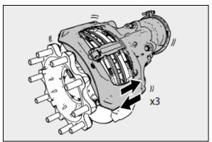
FIGURE 37: PUSH CALIPER THREE TIMES IN AXIAL DIRECTION
