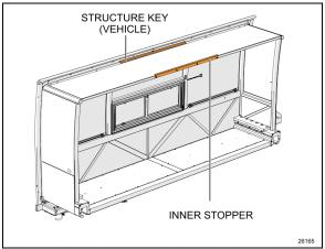
FIGURE 26: SLIDE-OUT UPPER STOPPER (FRONT LEFT SHOWN)
