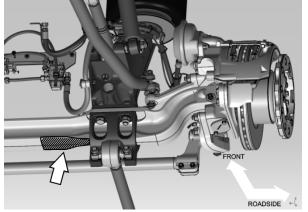
BSIDE FIGURE 9: I-BEAM AXLE HOISTING POINT - ROAD SIDE
