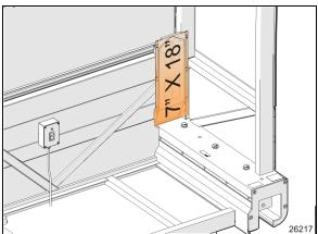
FIGURE 54: REAR RIGHT SLIDE-OUT "NO DRILLING" ZONE
