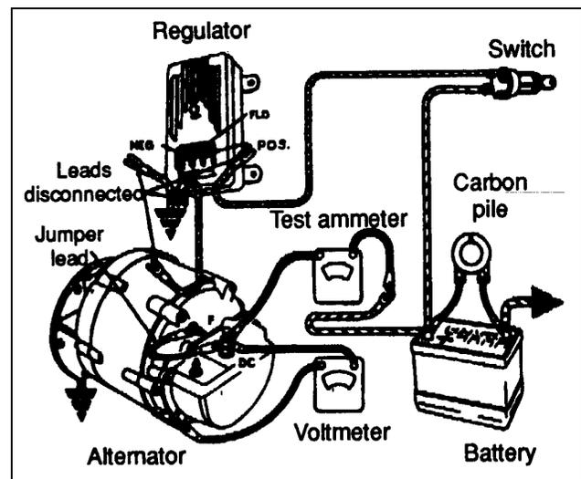
FIGURE 34: REGULATOR VOLTAGE TEST (UNDERCHARGED BATTERY) 06080
