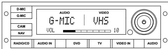
L'unité de commande audio-vidéo VSS-05 Video & Sound Selector permet au conducteur de sélectionner la source audio, audio/vidéo ou vidéo de divertissement et d'effectuer les réglages audio (volume, niveau des basses, des aigus, etc.) pour la section des passagers. Cette unité permet également de contrôler le lecteur DVD, un syntoniseur TV, les microphones et des systèmes audio ou vidéo auxiliaires.
