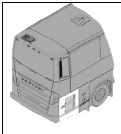
Cette porte peut être verrouillée/déverrouillée à l'aide de la clé des compartiments extérieurs. Soulever le couvercle protecteur pour accéder à la serrure. Ouvrir la porte en soulevant la poignée et en tirant.
