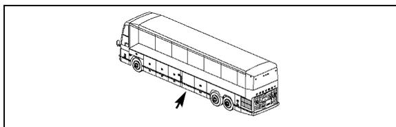
Le bouton de déverrouillage de la porte se trouve à l'intérieur du compartiment à bagages adjacent. Ouvrir le compartiment à bagages situé à droite. Tirer le bouton de déverrouillage situé sur la paroi commune de ces deux compartiments. Tirer ensuite sur la porte pour accéder au compartiment de l'évaporateur.
