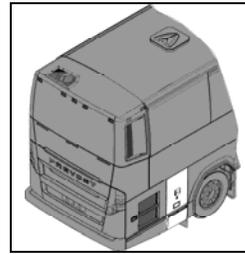
Ce compartiment peut être déverrouillé à l'aide de la clé des compartiments extérieurs. Soulever le couvercle protecteur pour accéder à la serrure puis tourner la clé.
