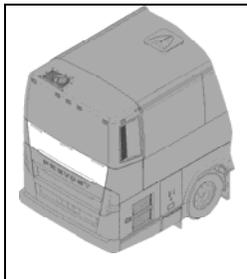
Pour ouvrir la porte d'accès au filtre à particules, ouvrir d'abord la porte du compartiment moteur. Poussez le levier de verrouillage vers le haut puis soulever la porte à deux mains jusqu'à ce qu'elle s'enclenche.
