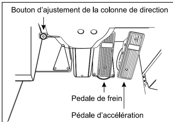
INCLINAISON ET RÉGLAGE TÉLESCOPIQUE
