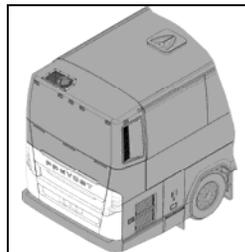
Pour ouvrir la porte arrière du compartiment moteur, ouvrir d'abord la porte d'accès au côté droit du moteur. Soulever le levier de déverrouillage vers le haut. Tirer le haut de la porte vers l'arrière.
