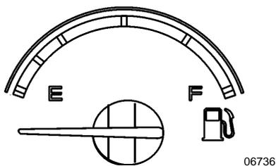
Indique la quantité approximative du carburant présent dans le réservoir. Lorsque l'aiguille atteint le début de la zone rouge, il reste environ 182 litres de carburant dans le réservoir.
