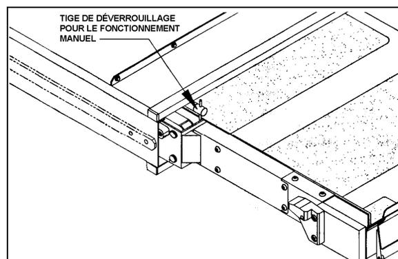
**TIGES DE DÉVERROUILLAGE DE LA PLATE-FORME**
