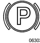
Ce témoin s'allume lorsque le frein de stationnement / d'urgence est appliqué. La soupape de commande est située sur le tableau de commande latéral gauche. Un signal sonore retentit si le commutateur d'allumage est à la position «OFF» mais que le frein de stationnement n'est pas appliqué.
