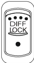
Basculer l'interrupteur vers l'avant pour verrouiller le différentiel. Voir la section "Autres Caractéristiques" pour les instructions complètes.
