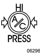
Lorsque la pression du système de climatisation est trop haute, ce témoin apparaît et le compresseur est débrayé. Quant au ventilateur du condenseur, il continue de fonctionner.
