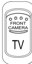
Basculer l'interrupteur vers le bas pour mettre en fonction la caméra et ainsi permettre aux passagers de visionner la route à partir des moniteurs. Lorsque la caméra n'est pas en fonction, les moniteurs peuvent servir au visionnement des cassettes vidéo.
