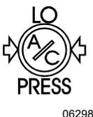
Lorsque la pression du système de climatisation est trop basse, ce témoin lumineux s'allume, le compresseur est débrayé et le ventilateur du condenseur s'arrête.
