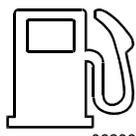
Ce témoin s'allume lorsqu'il reste environ 45 litres (12 gallons US.) dans le réservoir. Il est recommandé de ne pas franchir plus de 100 kilomètres (62 milles) alors que le témoin est allumé. Faire le plein dès que possible.
