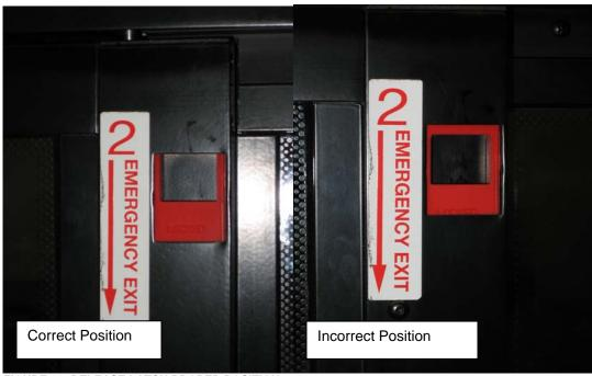
FIGURE 68: RELEASE LATCH PROPER POSITION
