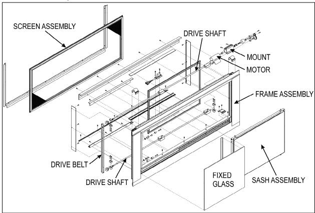
FIGURE 63: ELECTRIC SLIDING WINDOW EXPLODED VIEW
