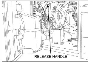
FIGURE 55: FRONT BUMPER RELEASE HANDLE
