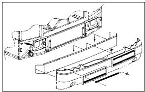
FIGURE 54: FRONT BUMPER REMOVAL
