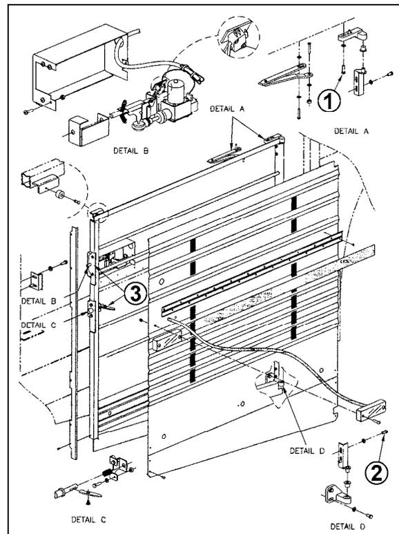
FIGURE 35: ENGINE COMPARTMENT R.H. SIDE DOOR<sup>18635</sup>
