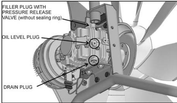
**FIGURE 26: RIGHT ANGLE GEARBOX** 05118\_4
