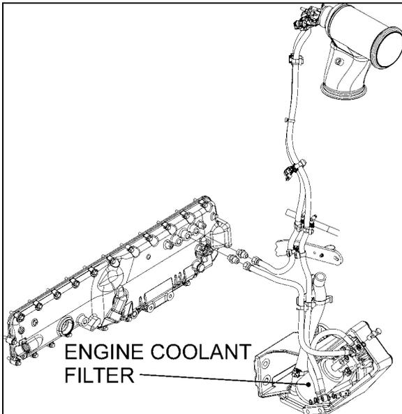
**FIGURE 17: COOLANT FILTER (VOLVO D13)** 05145
