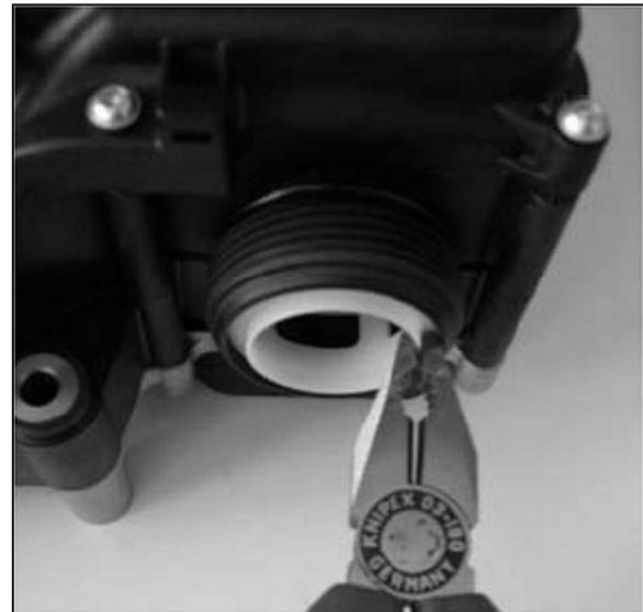
**FIGURE 12 : PUMP ASSEMBLY FILTER ELEMENT**
