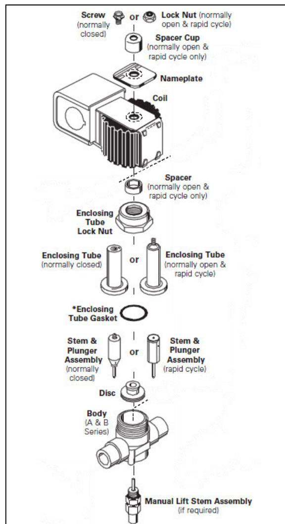
FIGURE 48: TYPICAL REFRIGERANT SOLENOID VALVE
