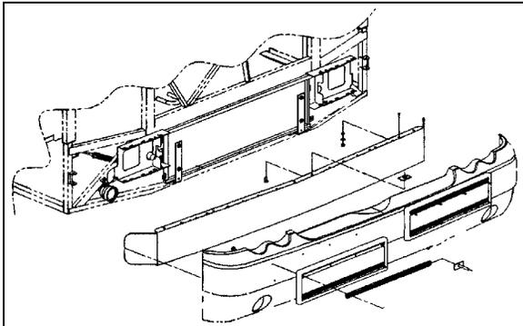
FIGURE 54: FRONT BUMPER REMOVAL
