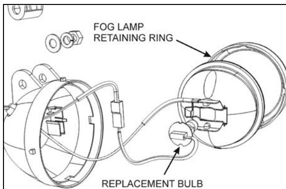
FIGURE 66: FOG LIGHT EXPLODED VIEW
