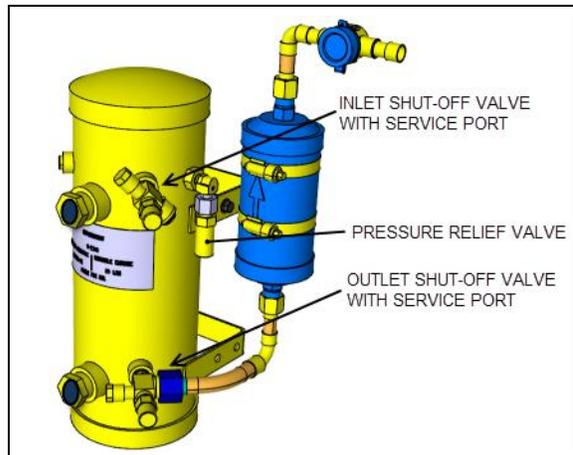
FIGURE 40: RECEIVER TANK
