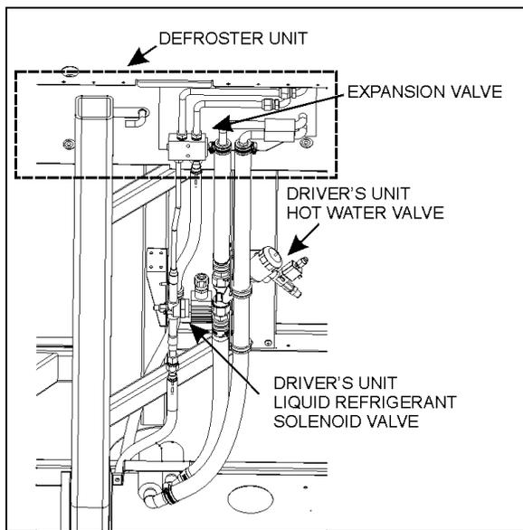
FIGURE 46: DRIVER'S UNIT LIQUID SOLENOID VALVE
