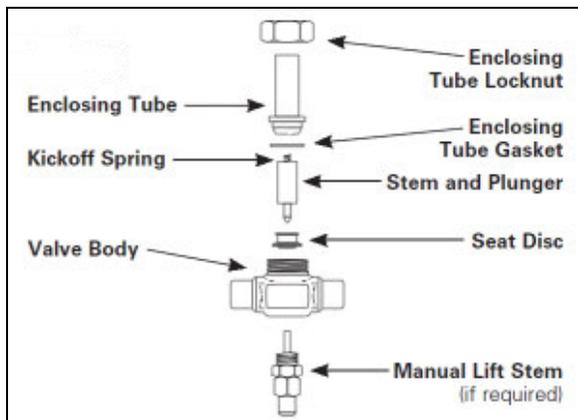
FIGURE 49: REFRIGERANT SOLENOID VALVE 22044
