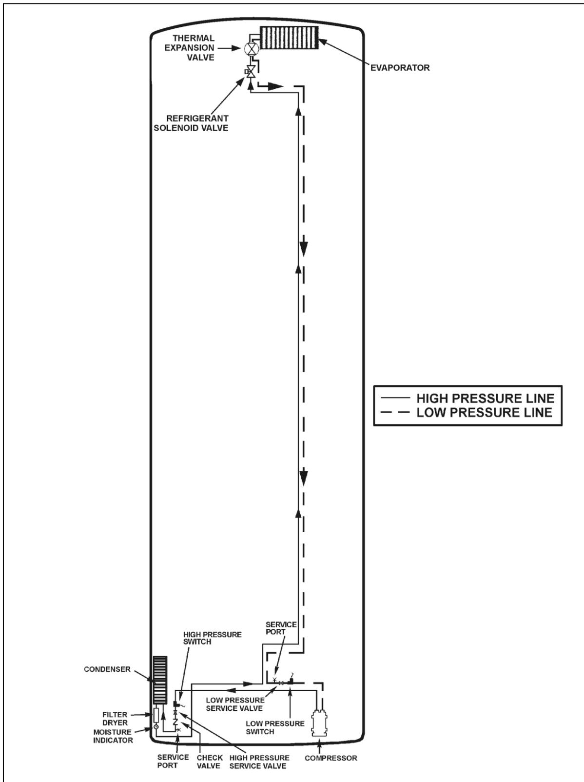
FIGURE 10: X3 SERIES SMALL HVAC SYSTEM - REFRIGERANT CIRCUIT
