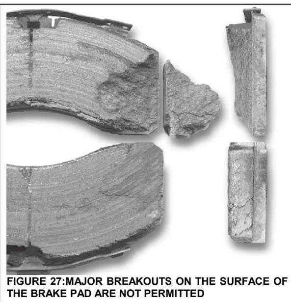
FIGURE 27: MAJOR BREAKOUTS ON THE SURFACE OF THE BRAKE PAD ARE NOT PERMITTED
