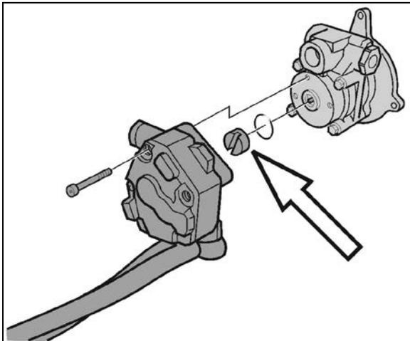
FIGURE 7: FUEL PUMP DRIVE AXLE
