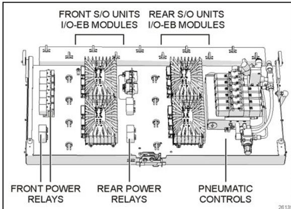
FIGURE 38: SLIDE-OUT CONTROL PANEL
