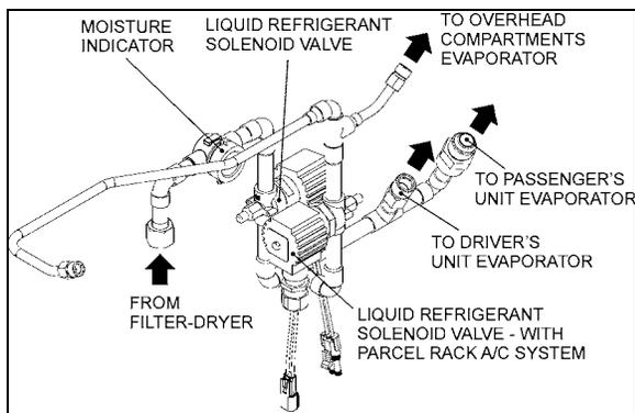
FIGURE 47: LIQUID REFRIGERANT SOLENOID VALVES INSIDE CONDENSER COMPARTMENT
