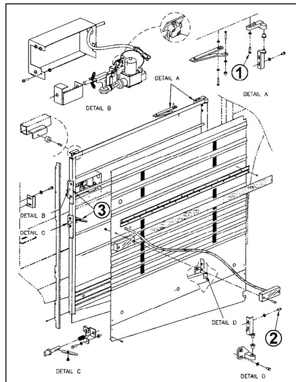
FIGURE 73: ENGINE COMPARTMENT R.H. SIDE DOOR<sup>18635</sup>
