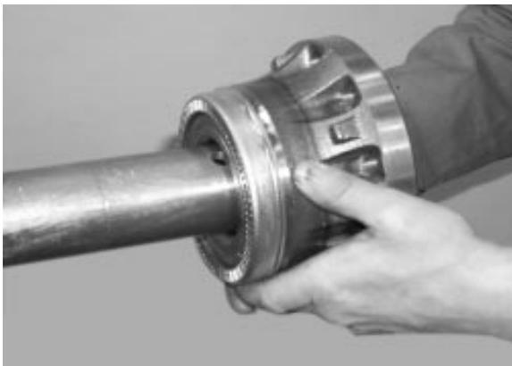
FIGURE 11: SLIP UNITIZED HUB BEARING OVER SPINDLE
