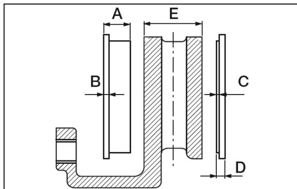
FIGURE 28: FRONT AXLE BRAKE AIR CHAMBER 12158
