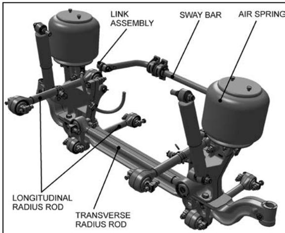
FIGURE 1: FRONT I-BEAM AXLE SUSPENSION 16105
