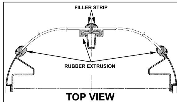
FIGURE 47: WINDSHIELD INSTALLATION TOP VIEW<sup>18098</sup>
