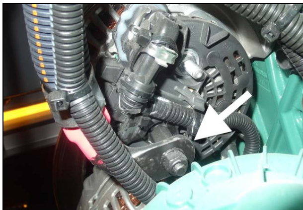
Figure 24: Cosse de câble de l'alternateur supérieur protégé avec le revêtement de protection Color Guard.
