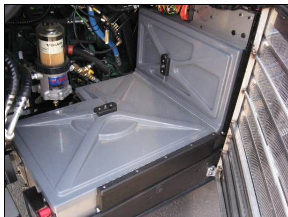
FIGURE 8 : PANNEAU ÉLECTRIQUE ARRIÈRE, PANNEAU DE JONCTION ET COMPARTIMENT DES BATTERIES
