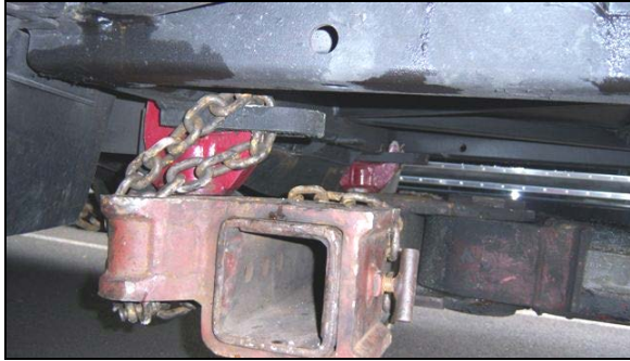
TOUJOURS ARRIMER LES OEUILLERS AU DISPOSITIF DE LEVAGE DU CAMION
