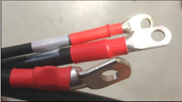
Figure 13: Les cosses de câble doivent être rondes et fermées. Elles sont serties ou soudées.
