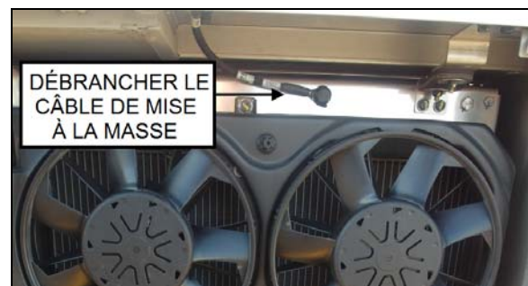
FIGURE 23: CÂBLE DE MISE À LA MASSE DU SYSTÈME DE REFROIDISSEMENT
