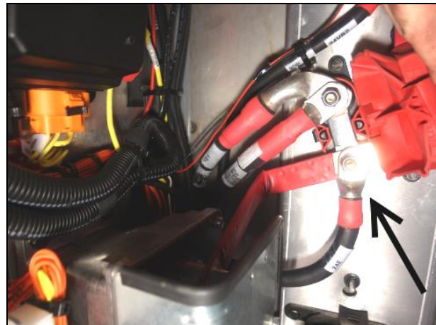
Figure 3: Bloc de jonction Bussman - Série H3
