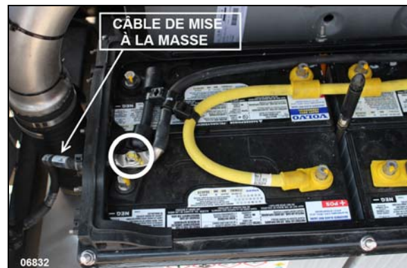
FIGURE 31: DÉCONNECTER LE CÂBLE DE MISE À LA MASSE EN PREMIER
