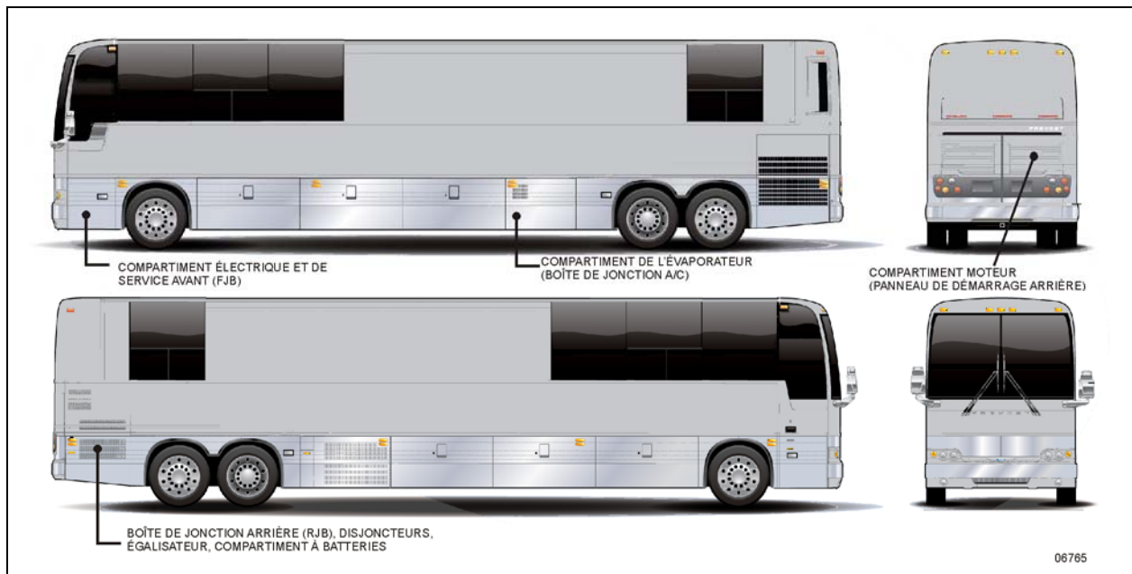
FIGURE 13 : COMPARTIMENTS ÉLECTRIQUES (X3-45 VIP)
