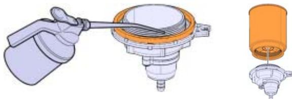
9. Assembler le filtre au bol. Serrer le filtre à la main. Ne pas trop serrer.
