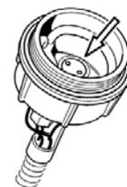
8. Nettoyer la surface de montage du joint d'étanchéité de la cuve de séparation. Appliquer une fine couche d'huile à moteur propre sur cette surface avant l'installation du joint d'étanchéité. N'installez pas de filtre
