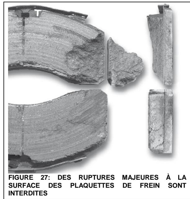
FIGURE 27: DES RUPTURES MAJEURES À LA SURFACE DES PLAQUETTES DE FREIN SONT INTERDITES
