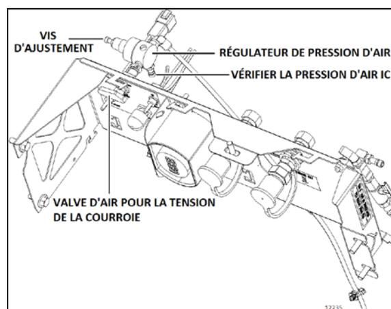
FIGURE 9: RÉGULATEUR DE PRESSON D'AIR (SÉRIE H)
