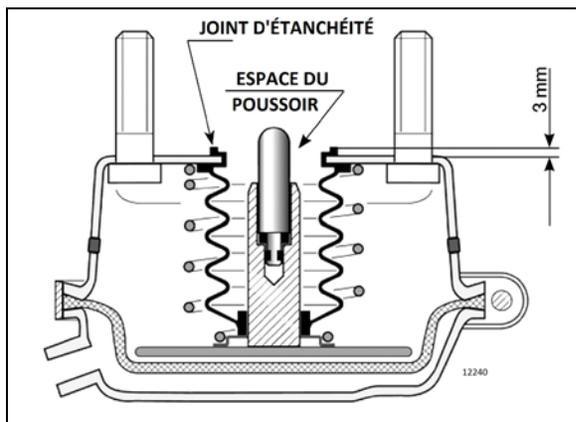
FIGURE 31: CYLINDRE RÉCEPTEUR DE FREIN D'ESSIEU MOTEUR
