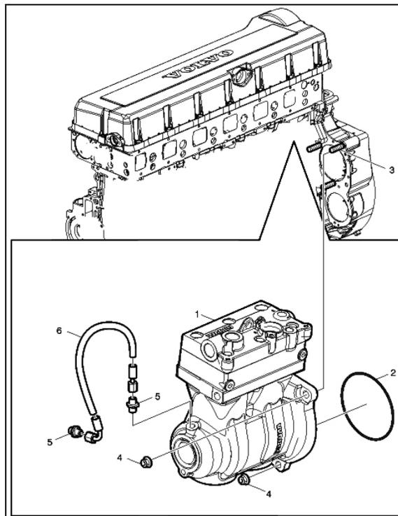
FIGURE 10 : EMLACEMENT DU COMPRESSEUR D'AIR
