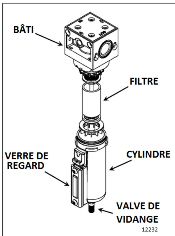
FIGURE 4: FILTRE À AIR D'ACCESSOIRE
