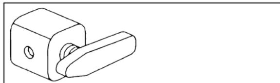
FIGURE 21: VALVE À TROIS VOIES 12186
