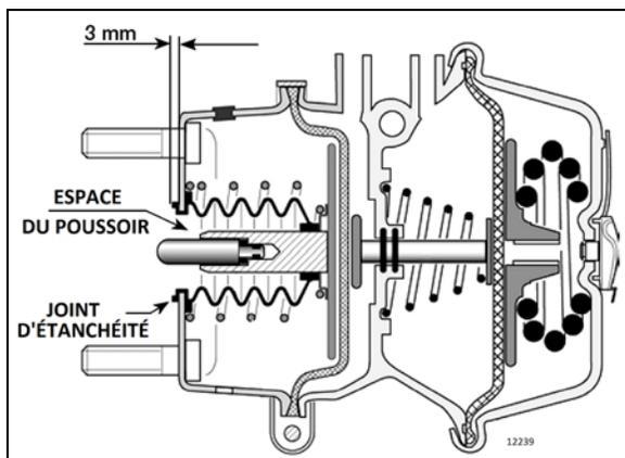
FIGURE 30: CYLINDRE RÉCEPTEUR DE FREIN D'ESSIEU MOTEUR
