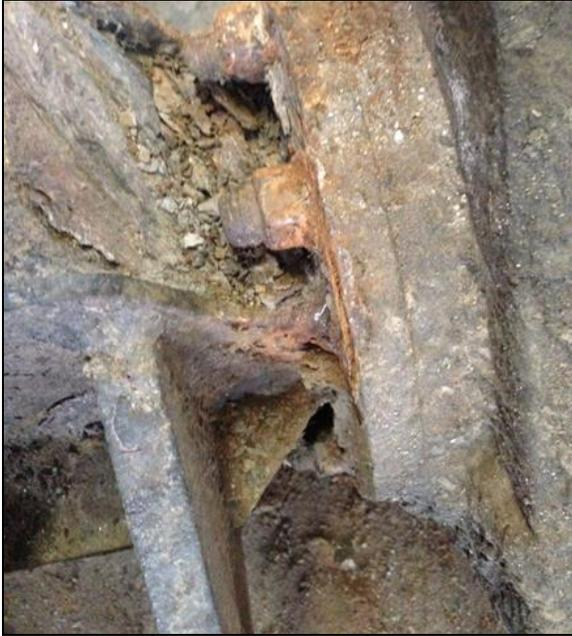
FIGURE 4: ÉCAILLAGE DU MÉTAL SUR L'ESSIEU AUXILIAIRE - DE LA MATIÈRE ACCUMULÉE PEUT RETENIR L'EAU ET CAUSER UN MILIEU PROPICE À LA CORROSION
