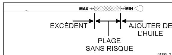
FIGURE 11 : JAUGE DE NIVEAU D'HUILE À MOTEUR
