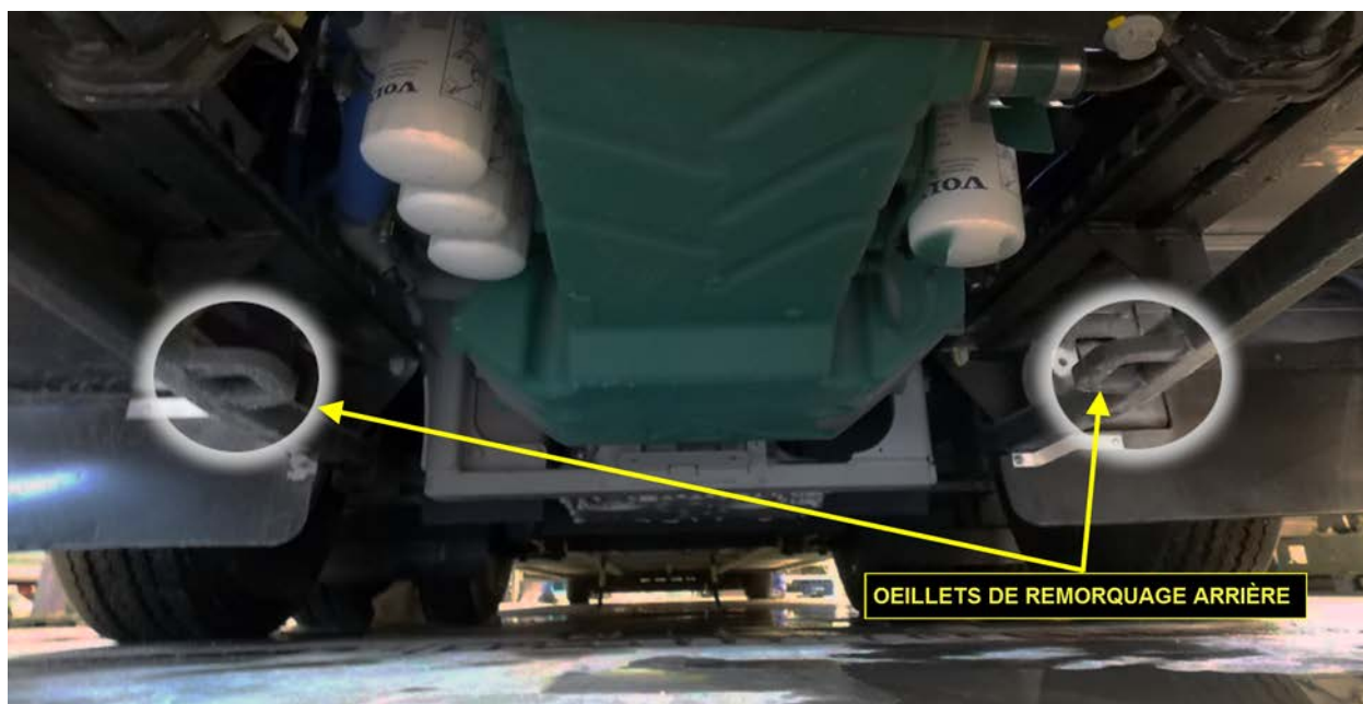
FIGURE 52: OEILLETS DE REMORQUAGE ARRIÈRE EN OPTION SUR LES LONGERONS SOUS LE SUPPORT DU MOTEUR
