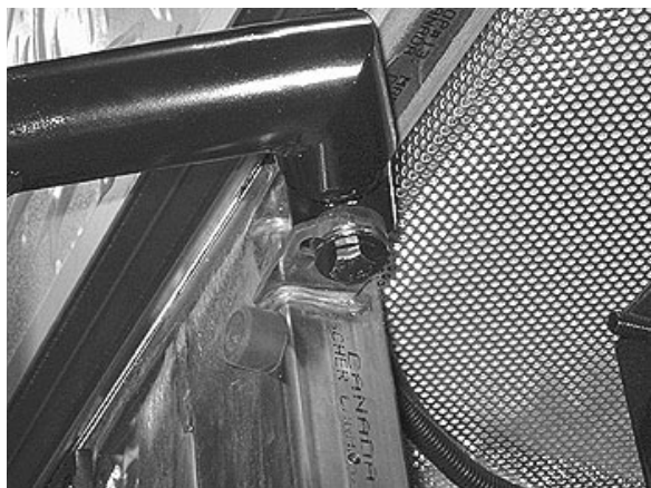
FIGURE 67: AJUSTEMENT DE LA PROFONDEUR DE LA PORTE
