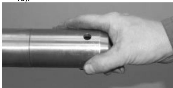
FIGURE 18 : OUTIL D'INSERTION N/P PREVOST 491115
