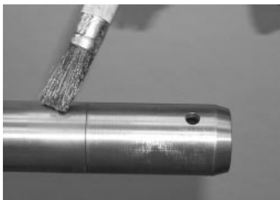
FIGURE 10 : APPLIQUER LA GRAISSE GLEITMO 805
