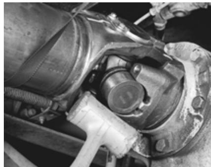
FIGURE 14: DÉGAGER LES EMBOUTS DE JOINTS
