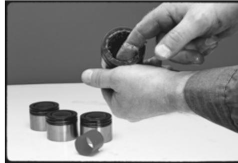
FIGURE 28: GRAISSAGE DES COUPELLES DE ROULEMENT
