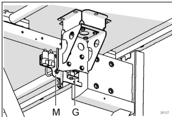
FIGURE 58 : PALIER DE PLANCHER &amp; CONTACTEURS DE PROXIMITÉ
