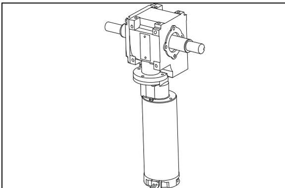
FIGURE 40: MOTEUR ÉLECTRIQUE ET RÉDUCTEUR DE VITESSE
