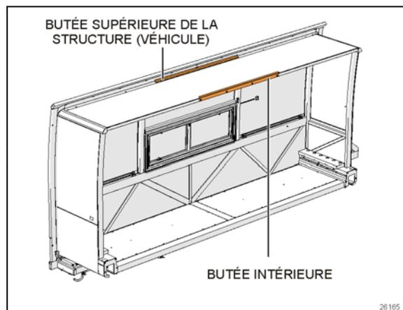
FIGURE 9: BUTÉE SUPÉRIEURE INTÉRIEURE
