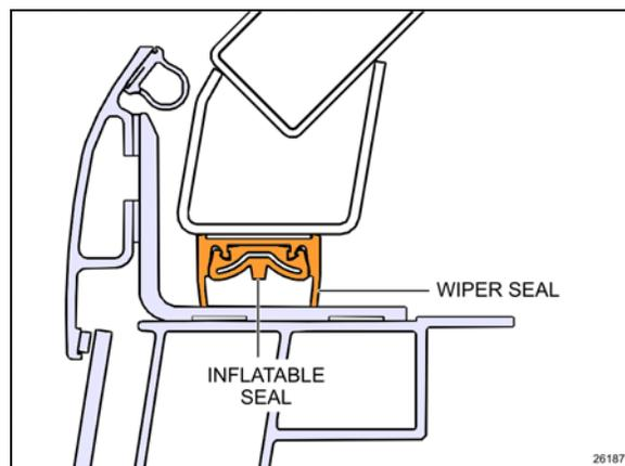
FIGURE 29: ASEMBLAGE DU JOINT D'ÉTANCHÉITÉ 26160
