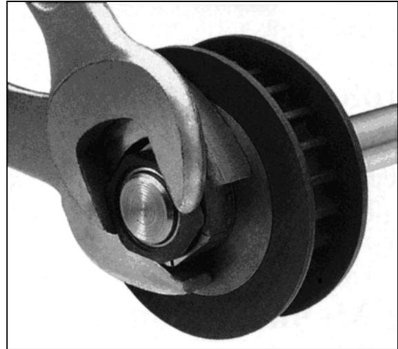
FIGURE 16: SERRAGE DE LA BAGUE SANS CLAVETTE
