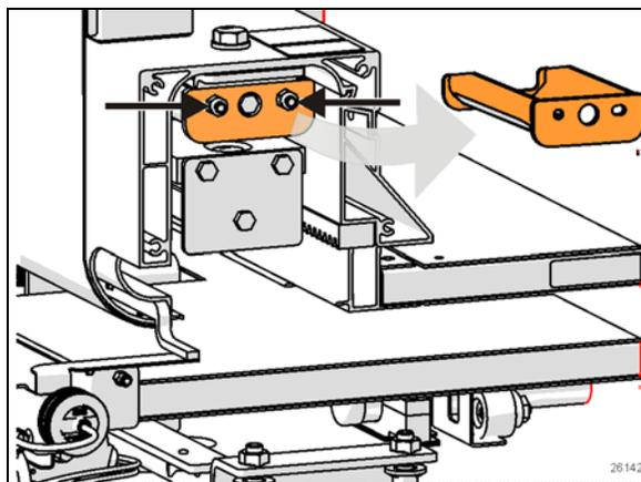
FIGURE 67 ÉCROUS DE MONTAGE DE LA BUTÉE
