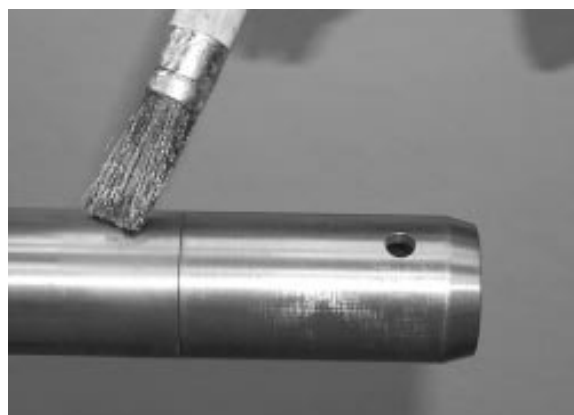
FIGURE 19 : APPLIQUER LA GRAISSE GLEITMO 805
