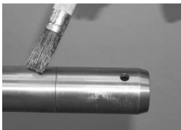
FIGURE 10 : APPLIQUER LA GRAISSE GLEITMO 805
