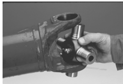
FIGURE 29: POSITIONNER LE CORPS DU JOINT UNIVERSEL À L'INTÉRIEUR DE LA FOURCHE AVEC L'EMBOUT DE GRAISSAGE VERS L'INTÉRIEUR POINTANT VERS LE TUBE.
