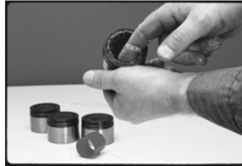
FIGURE 28: GRAISSAGE DES COUPELLES DE ROULEMENT
