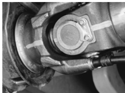
FIGURE 26: ALIGNER LES MARQUES D'INDEX DE LA FOURCHE ET DE L'ARBRE DE TRANSMISSION.
