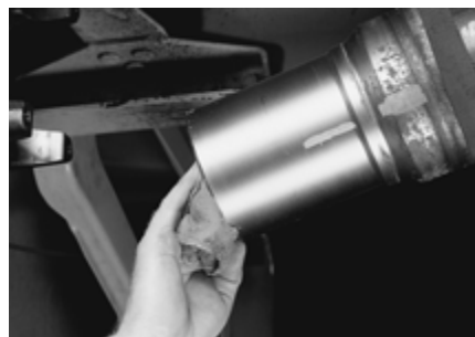
FIGURE 23: NETTOYER LA GRAISSE DU MANCHON CANNELÉ
