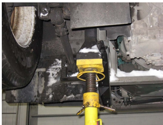
FIGURE 20: CHANDELLE AU SUPPORT DE LEVAGE - À L'ARRIÈRE DE L'ESSIEU AUXILIAIRE, CÔTÉ TROTTOIR
