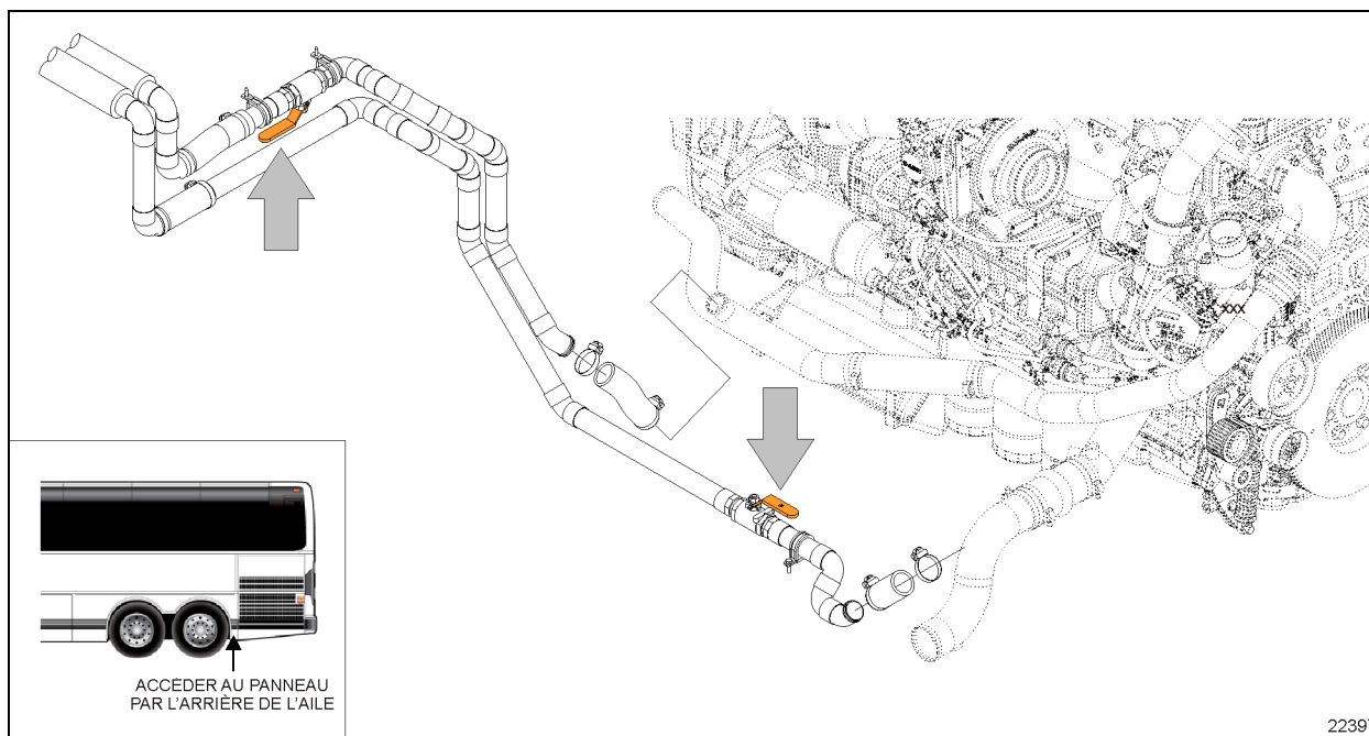
FIGURE 77 ROBINETS D'ARRÊT DE LA LIGNE DE CHAUFFAGE DE LA SÉRIE X (DISPOSITION DE TUYAUTERIE DE TRANSMISSION ALLISON ILLUSTRÉE)
