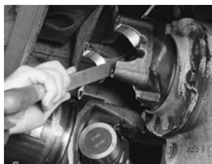
FIGURE 15: EFFRITEMENTS DE MÉTAL ET ENCAVURES SUR LES SURFACES DE MONTAGE DE LA FOURCHE.
