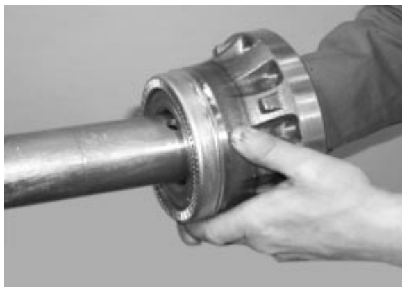
FIGURE 20 : FAIRE GLISSER LE ROULEMENT DE MOYEU INTÉGRÉ PAR-DESSUS LA FUSÉE
