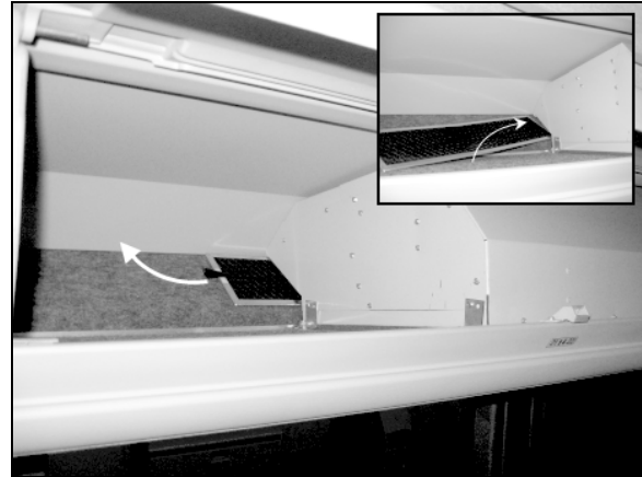
FIGURE 23: FILTRE À AIR DU VENTILATEUR DU PORTE-BAGAGES À MAIN
