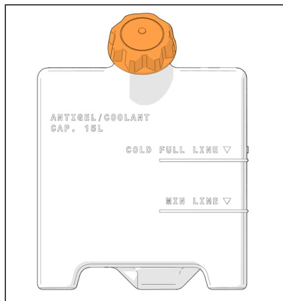
Remplir le réservoir avec le même mélange 50/50 eau-antigel déjà présent dans le système de refroidissement. Ne pas mélanger de mélange d'antigel différent. Se référer au manuel d'entretien pour le type et les spécifications de l'antigel recommandé ou consulter le décalque apposé sur le réservoir d'expansion du véhicule.
