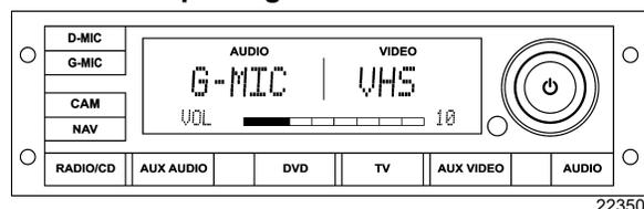
L'unité de commande audiovisuelle « VSS-05 Sound Selector » permet au conducteur de sélectionner la source audio, audio/vidéo ou vidéo de divertissement et d'effectuer les réglages audio (volume, niveau des basses, des aigus, etc.) pour la section des passagers. Cette unité permet également de contrôler le lecteur DVD, un syntoniseur TV, les microphones et des systèmes audio ou vidéo auxiliaires.
