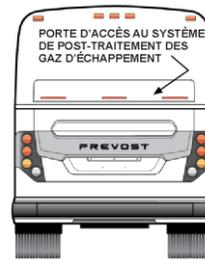
La porte d'accès au moteur doit être ouverte avant d'ouvrir la porte d'accès au système de post-traitement des gaz d'échappement. Pour ouvrir la porte, abaisser le bouton du loquet.
