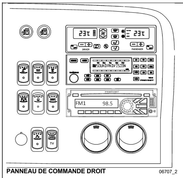
Le panneau de commande droit du tableau de bord comprend les interrupteurs de commande pour l'éclairage intérieur de l'autocar. Il comprend également les interrupteurs de la porte d'entrée, l'interrupteur de la caméra du système de visionnement des scènes panoramiques, le bouton de réglage de l'intensité lumineuse, le système de divertissement, l'unité de commande de CVC ainsi que des bouches d'air réglables pour le conducteur.
