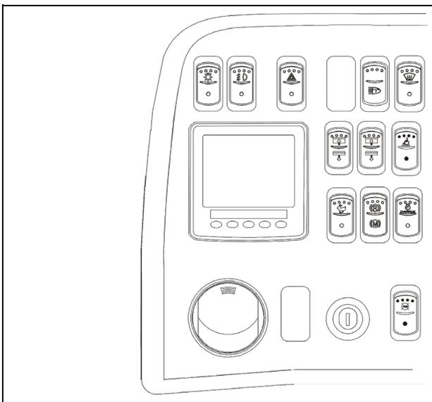
Le panneau de commande gauche du tableau de bord comprend les interrupteurs de commande pour la conduite de l'autocar. Il comprend également le commutateur d'allumage et une bouche d'air réglable pour le conducteur.
