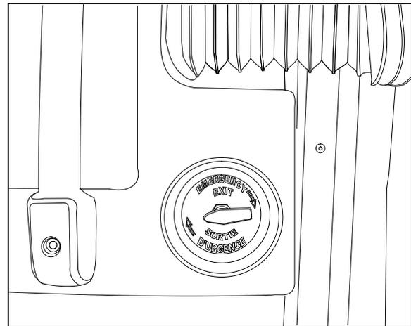
SOUPAPE INTÉRIEURE D'OUVERTURE D'URGENCE<sup>12164</sup>
