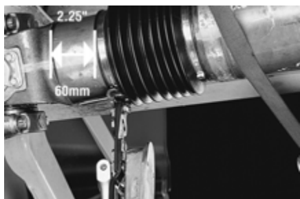
FIGURE 25: POSITIONNER L'EXTRÉMITÉ DU SOUFFLET À LA MARQUE DE 2.25 POUÇES (55-60MM) FAITE SUR ÉPAULEMENT DE L'ARBRE.
