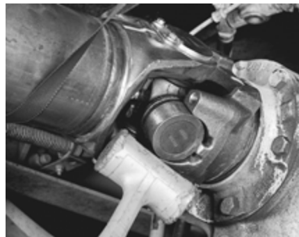
FIGURE 14: DÉGAGER LES EMBOUTS DE JOINTS
