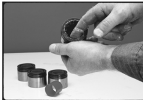
FIGURE 28: GRAISSAGE DES COUPELLES DE ROULEMENT
