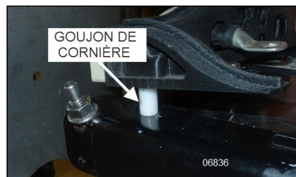
FIGURE 52 : GOUJON DE CORNIÈRE ET GUIDE DE CÂBLE
