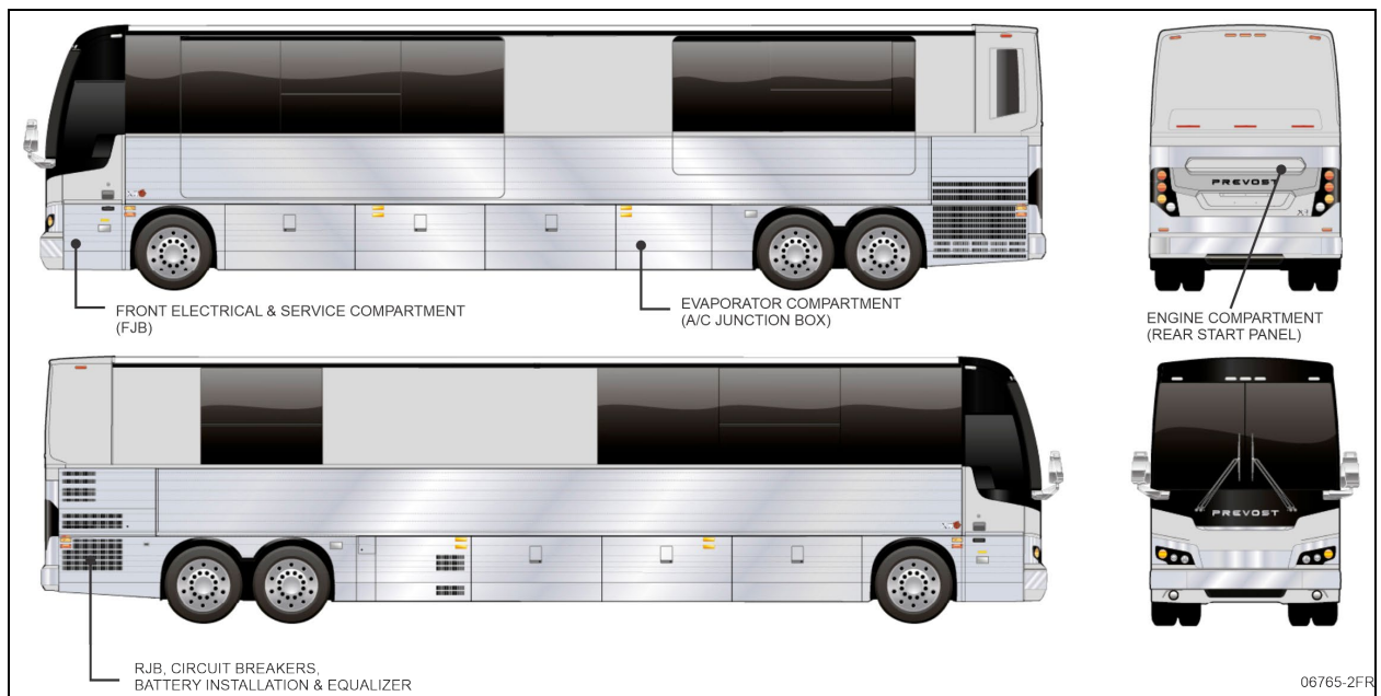
FIGURE 14 : COMPARTIMENTS ÉLECTRIQUES (X3-45 VIP)
