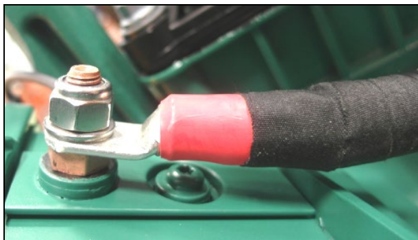
Figure 16: Aucun brin de cuivre apparent.
