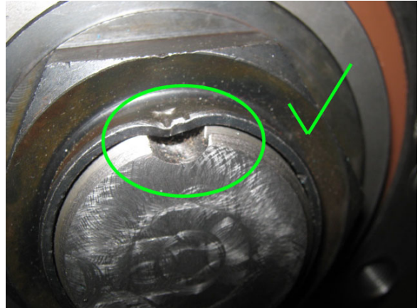
FIGURE 24: CORRECT - EMPÊCHE L'ÉCROU DE SE DESSERRER
