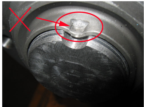
FIGURE 26: CREUX BRISÉ OU DÉCHIRÉE - REJETÉ
