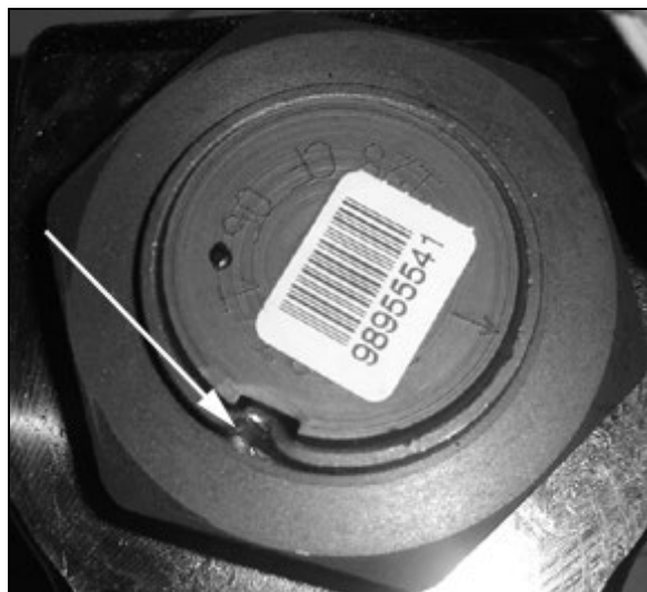
FIGURE 20 : MARQUE DE POINÇON D'ÉCROU DE FIXATION
