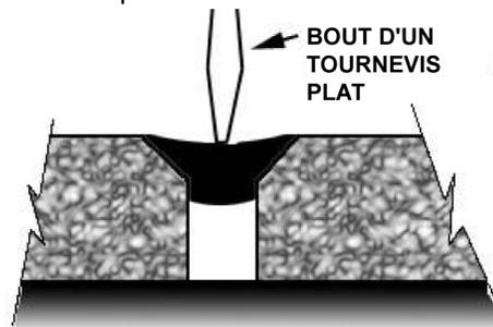
13. Si le soudage n'a pas été fait correctement, une perte d'adhérence pourra être observée sur un côté. Si tel est le cas, réparer le joint.
