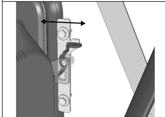
5. Vérifier l'ajustement de la poignée. Elle doit rester serrée contre son boîtier en plastique.
