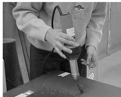
7. Une fois que la tête de soudage est prête, insérer le produit dans la buse et commencer le soudage immédiatement. Bouger de façon régulière en appuyant légèrement avec la tête de soudage.
