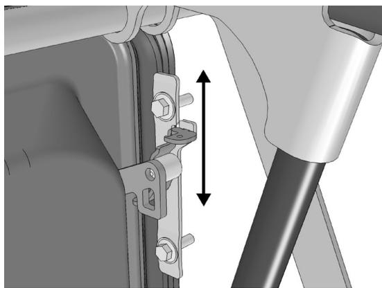
16. Ouvrir la porte du compartiment à bagages et ajuster le bloc de montage du vérin.
