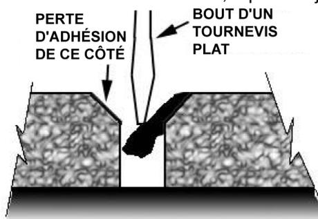
**9.10.3 Réparation d'un joint soudé****NOTE**
