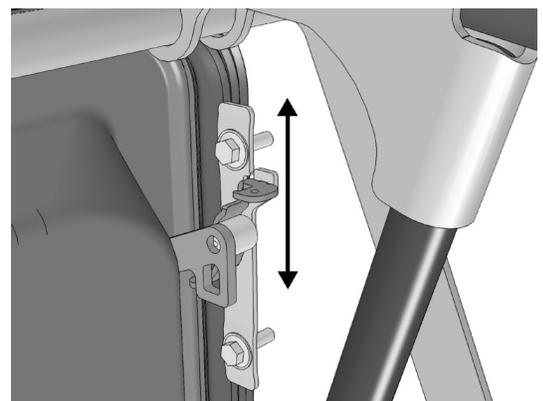
6. Ouvrir la porte du compartiment à bagages et ajuster le bloc de montage du vérin.
