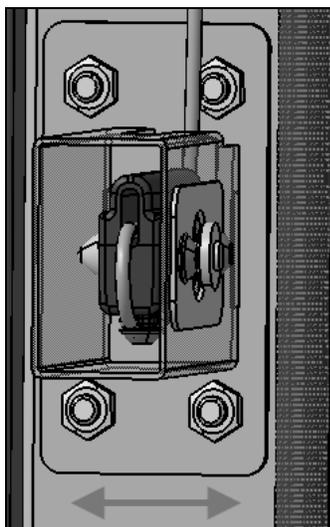
12. S'assurer que la plaque de fixation est parallèle à la structure avant de serrer le matériel de fixation du support de retenue.
