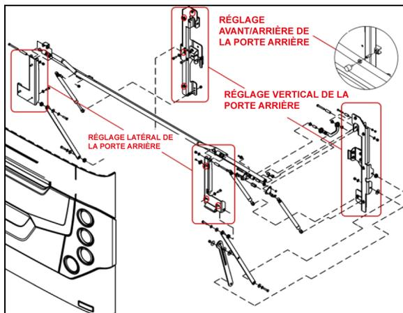
FIGURE 45 : PORTE DU COMPARTIMENT MOTEUR<sup>18633\_1</sup>
