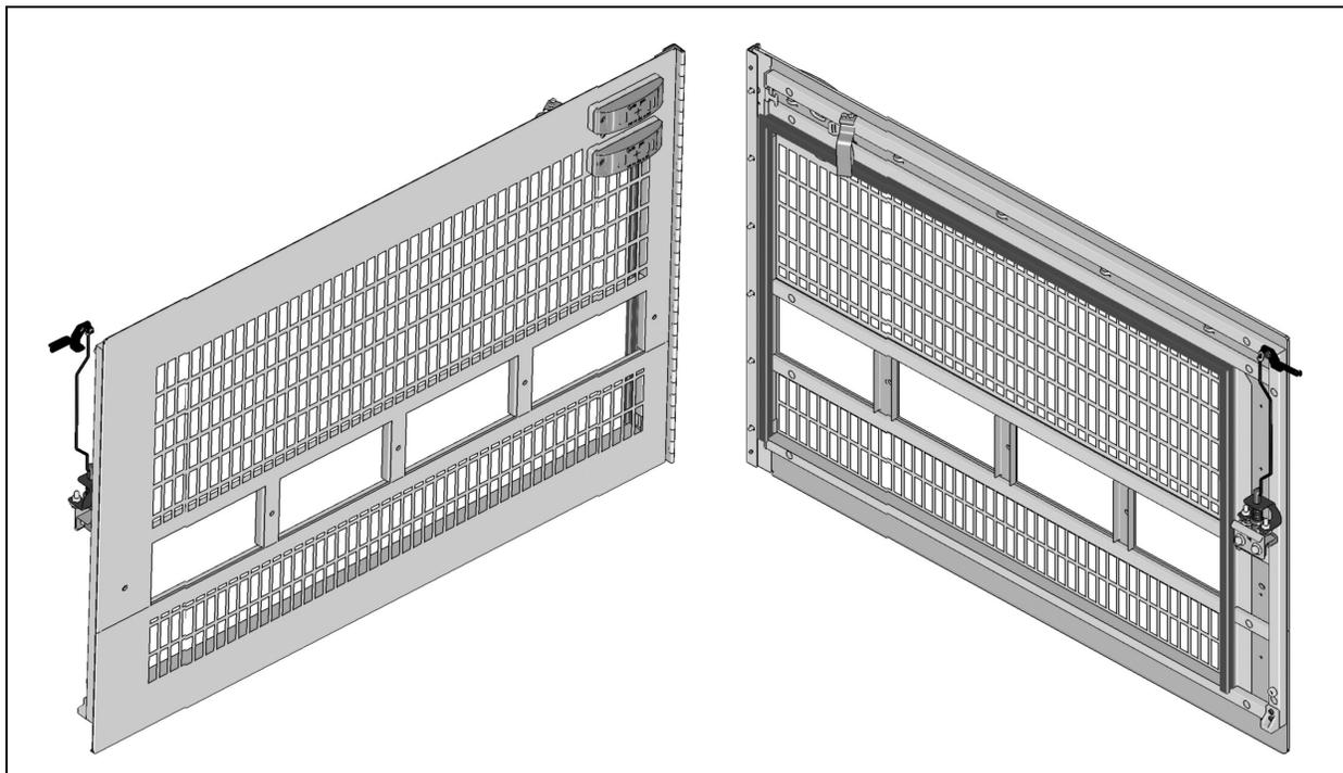
FIGURE 136 : PORTE DU COMPARTIMENT DU CONDENSEUR
