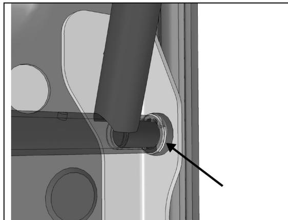
14. Ajuster la position de la porte et l'aligner sur les panneaux et les portes adjacents.
