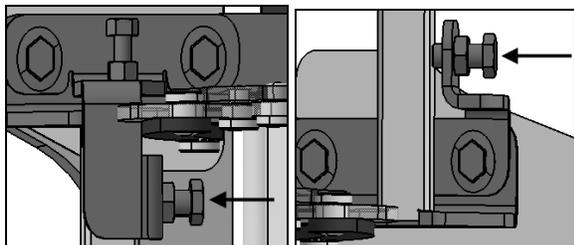
5. Pour ajuster la porte en profondeur, dévisser les vis fixant la charnière au châssis et glisser la charnière horizontalement pour faire entrer et sortir la porte. Selon l'emplacement, le panneau extérieur de la porte du côté de la charnière doit se trouver à 29 mm +/- 2 mm du châssis de l'autocar ou à 5 mm + 1 mm si la mesure est prise à partir du petit tube carré du châssis.
