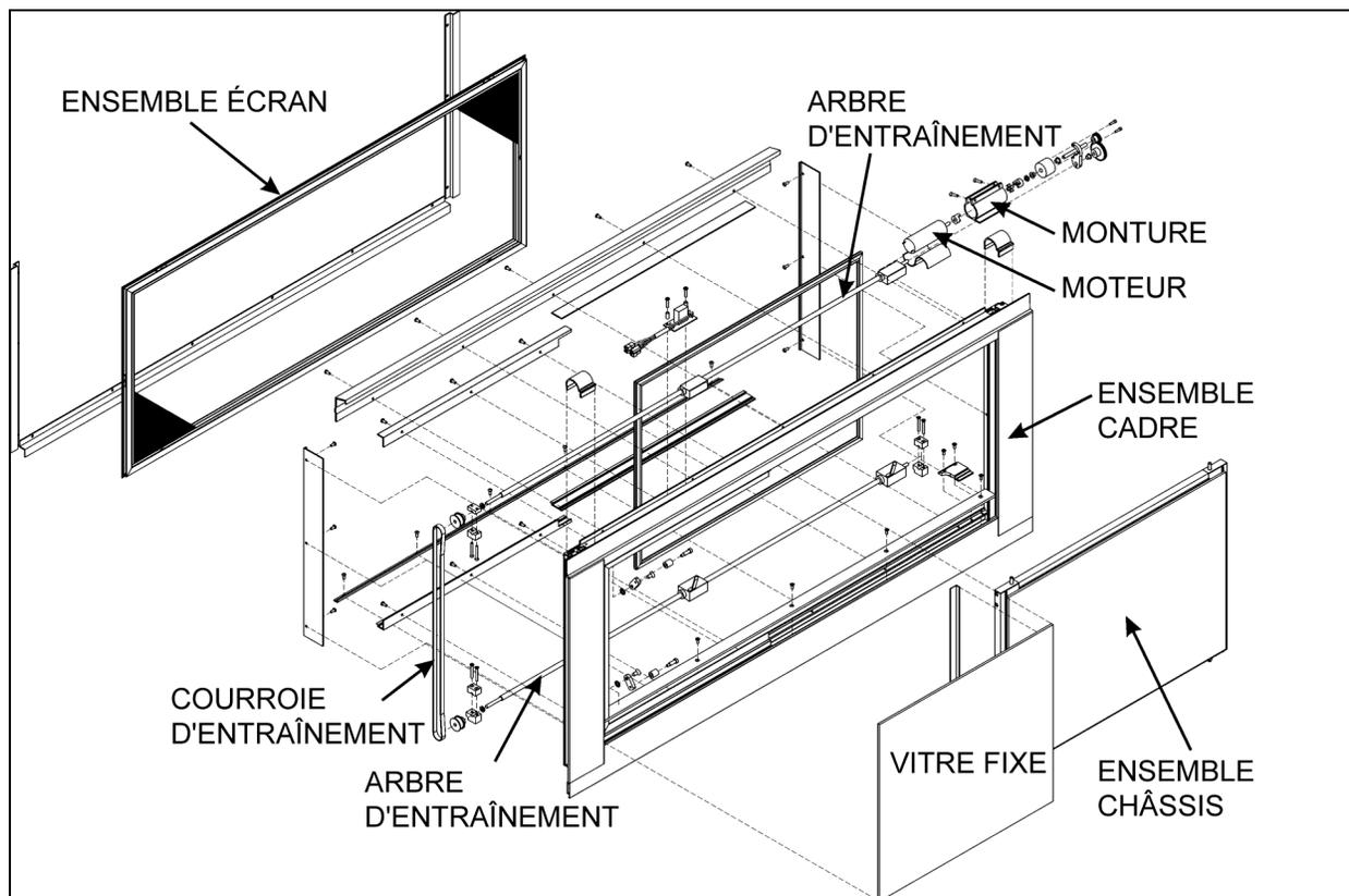
FIGURE 102 : VUE ÉCLATÉE D'UNE FENÊTRE ÉLECTRIQUE COULISSANTE
