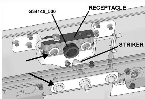
2. Fermer la porte pour centrer le mécanisme de verrouillage.
