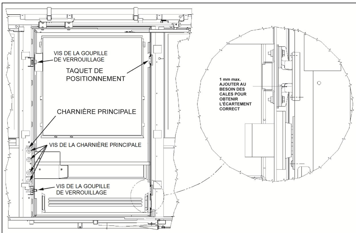
FIGURE 72: INSTALLATION DE LA PORTE COULISSANTE D'ACCÈS À L'ÉLÉVATEUR POUR FAUTEUILS ROULANTS
