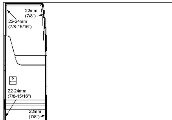
FIGURE 29 : AJUSTEMENT DE LA COMPRESSION DU JOINT 18632
