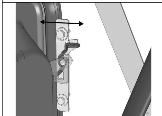
15. Vérifier l'ajustement de la poignée. Elle doit rester serrée contre son boîtier en plastique.
