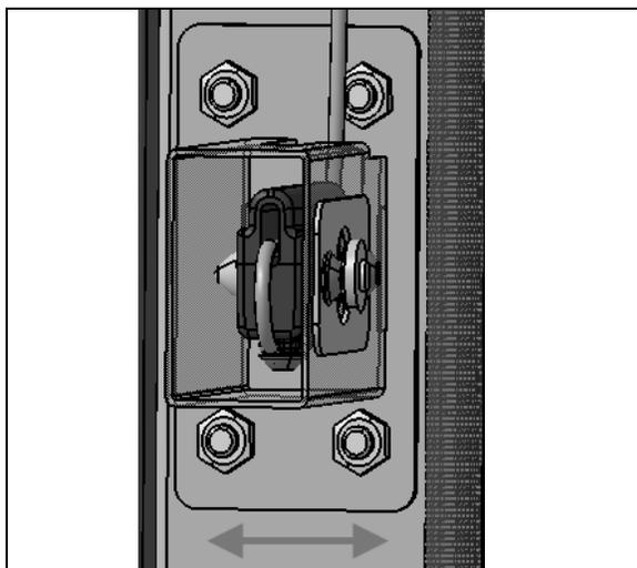
12. S'assurer que la plaque de fixation est parallèle à la structure avant de serrer le matériel de fixation.
