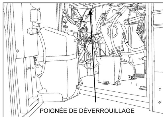
FIGURE 94: POIGNÉE DE DÉVERROUILLAGE DU PARE-CHOC AVANT 18613
