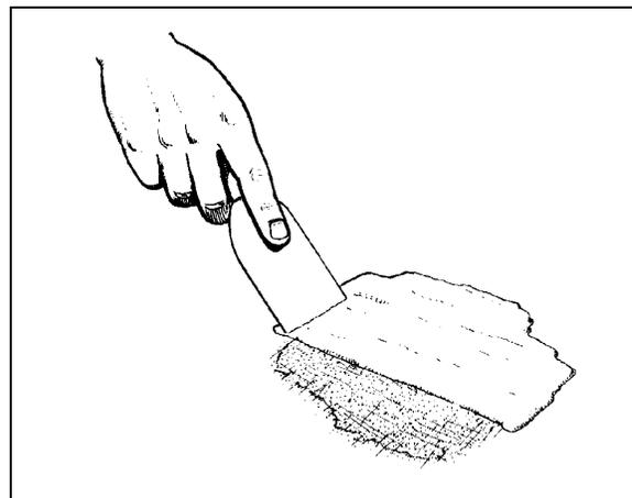
FIGURE 9 : RÉPARATION AVEC DE LA FIBRE DE VERRE 18093
