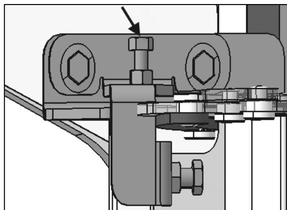
4. En utilisant les deux vis d'ajustement latérales (supérieures et inférieures), ajuster la porte pour avoir un jeu latéral de 6 à 8 mm. (le jeu doit être égal des deux côtés)
