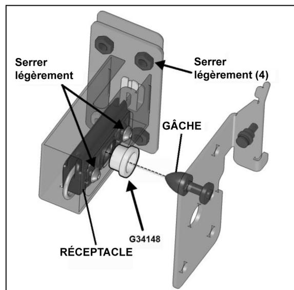
9. Fermer la porte pour centrer le mécanisme de verrouillage.
