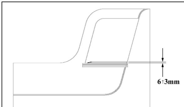
Gouttière de la fenêtre du conducteur
