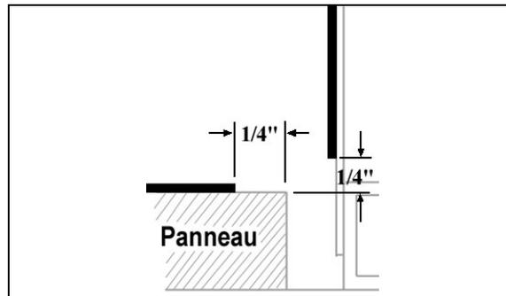
Dans le cas d'un joint de finition frontal, appliquer du ruban de masquage de chaque côté du joint.
