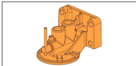
FIGURE 4: SUPPORT DU FILTRE DE LIQUIDE DE REFROIDISSEMENT
