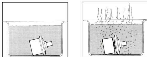
2. Après au minimum 30 secondes, vérifier que le thermostat est toujours fermé.
