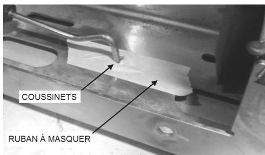
14. Positionner le refroidisseur d'air (CAC) dans le véhicule. Installer les deux vis à tête hexagonale du cadre inférieur pour fixer le refroidisseur. N'oubliez pas d'installer les coussinets isolants et les rondelles plates. Serrer les vis à la valeur de couple spécifiée ci-dessous.
