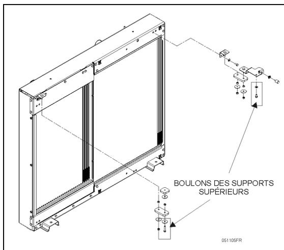
FIGURE 52: VIS DE MONTAGE DES SUPPORTS SUPÉRIEURS
