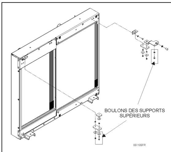
FIGURE 36: VIS DE MONTAGE DES SUPPORTS SUPÉRIEURS
