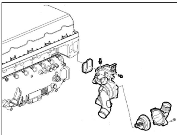
FIGURE 15 : BOÎTIER DU THERMOSTAT - VOLVO D13
