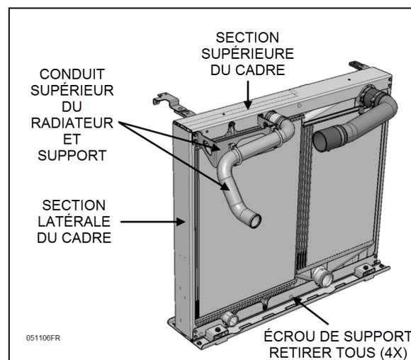
FIGURE 53: ÉLÉMENTS À DÉMONTER POUR LE REMPLACEMENT DU RADIATEUR
