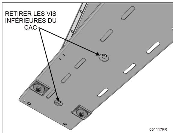
FIGURE 64: VIS DU DESSOUS DU REFROIDISSEUR D'AIR (CAC)
