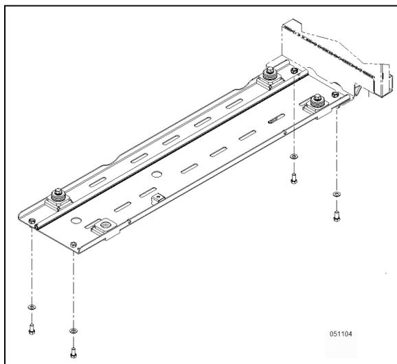
FIGURE 51: VIS DE MONTAGE DU SUPPORT INFÉRIEUR
