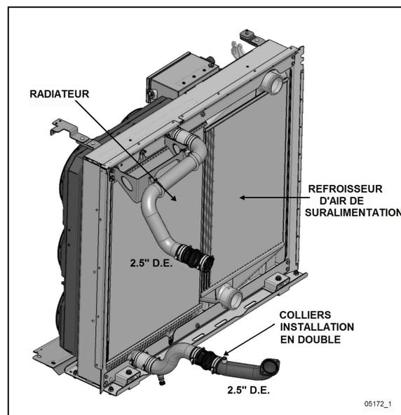
FIGURE 11: CIRCULATION DU LIQUIDE DE REFROIDISSEMENT (SÉRIE X3)
