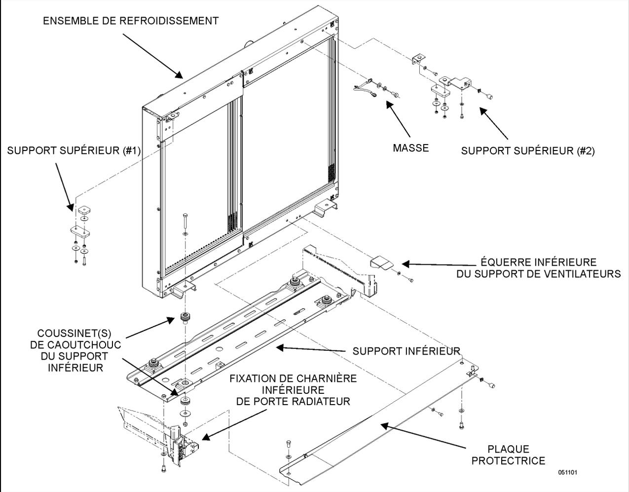
FIGURE 33: COMPOSANTS ET SUPPORTS DU MODULE DE REFROIDISSEMENT
