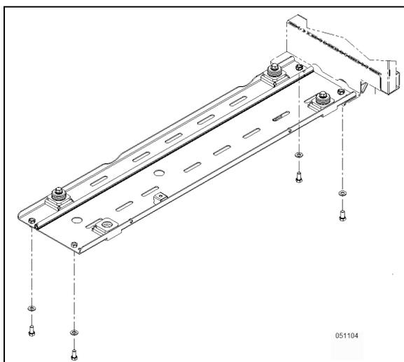
FIGURE 35: VIS DE MONTAGE DU SUPPORT INFÉRIEUR
