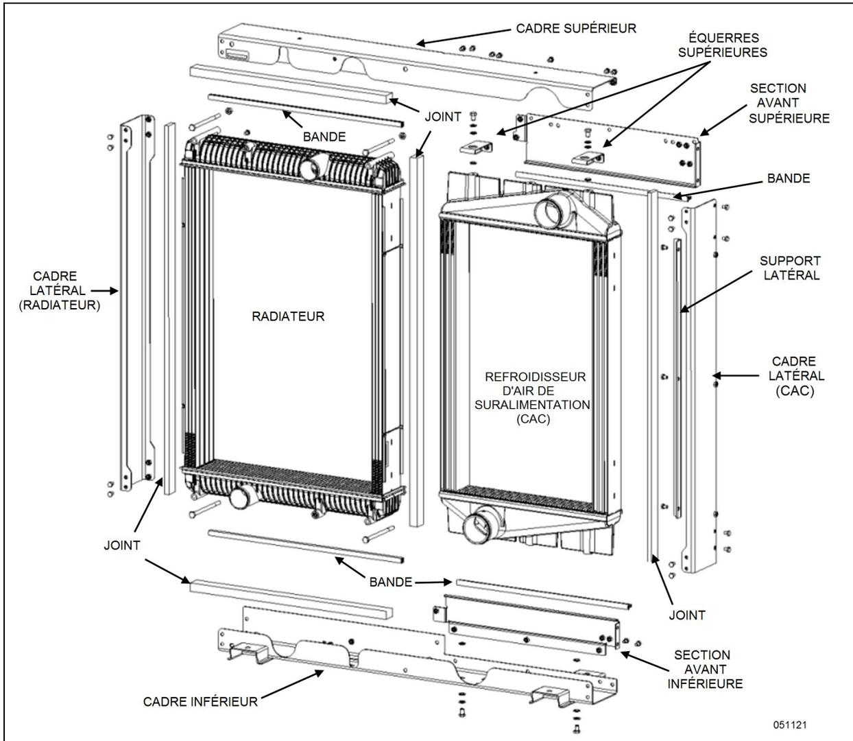
FIGURE 60: VUE ÉCLATÉE DU MODULE DE REFROIDISSEMENT
