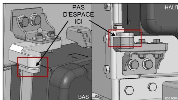
FIGURE 39: INSTALLATION DES CHARNIÈRES DU CARÉPAGE DE VENTILATEURS
