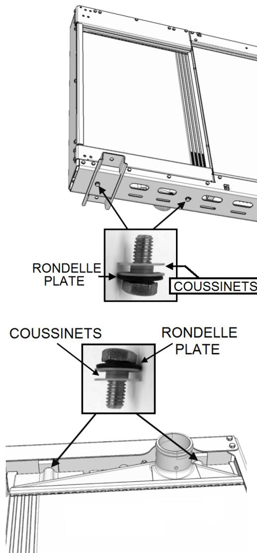
Après avoir terminé l'installation de l'unité de refroidissement, vérifier la conductivité entre le cadre du module de refroidissement et les faisceaux du refroidisseur d'air et du radiateur (un minimum de 100 000 ohms doit être mesuré).
