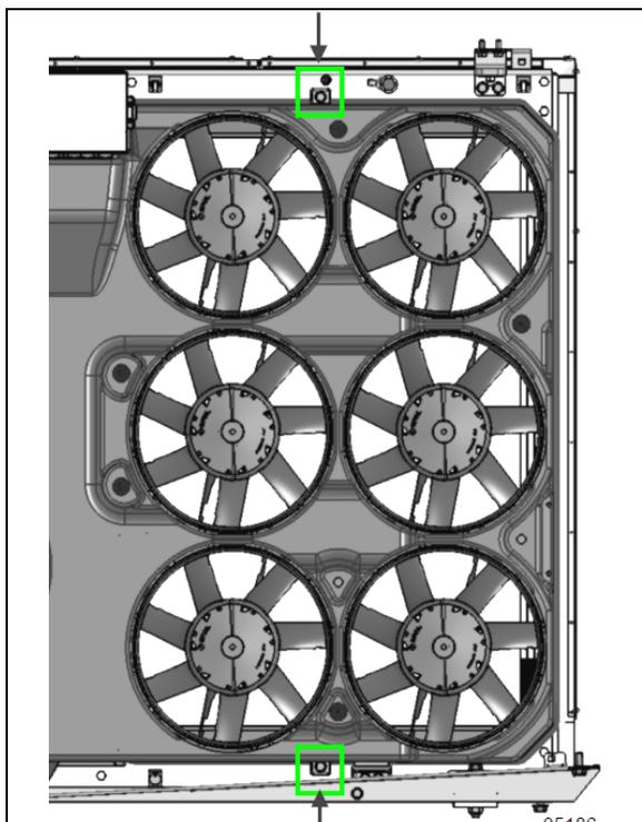
FIGURE 25: VIS INFÉRIURE ET SUPÉRIEURE DU CARÉNAGE DE VENTILATEURS
