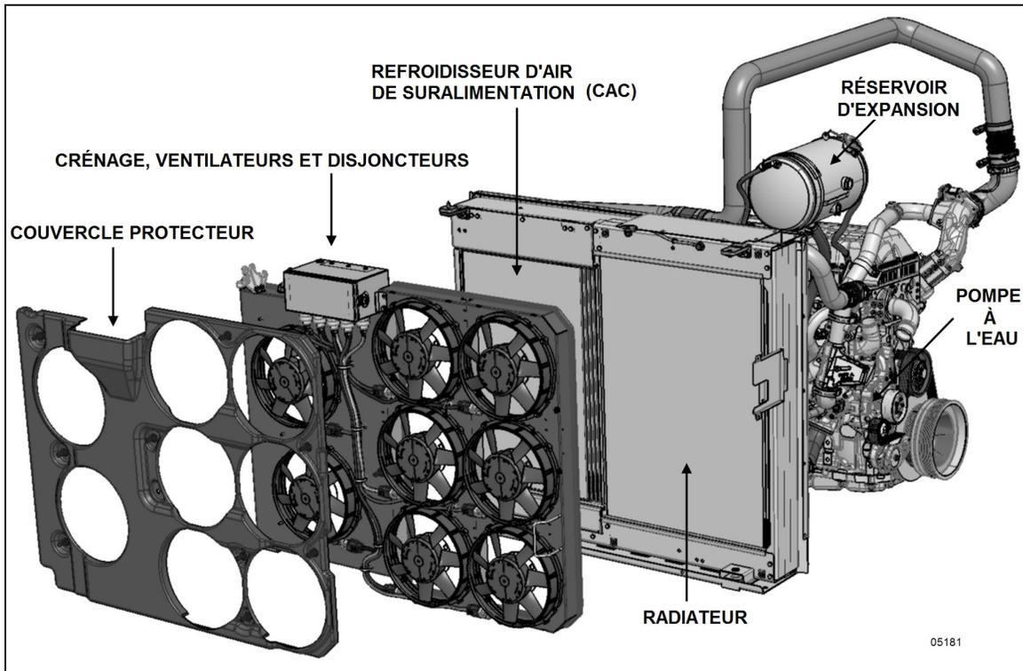
FIGURE 1: ASSEMBLAGE DU SYSTÈME DE REFOIDISSEMENT ET SES COMPOSANTS (SÉRIE X3 ILLUSTRÉE)
