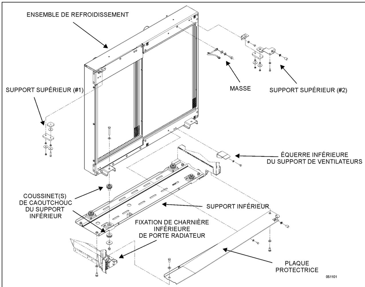
FIGURE 48: COMPOSANTS ET SUPPORTS DU MODULE DE REFROIDISSEMENT
