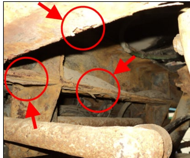
FIGURE 3: ÉCAILLAGE DU MÉTAL ET ACCUMULATION DE SABLE
