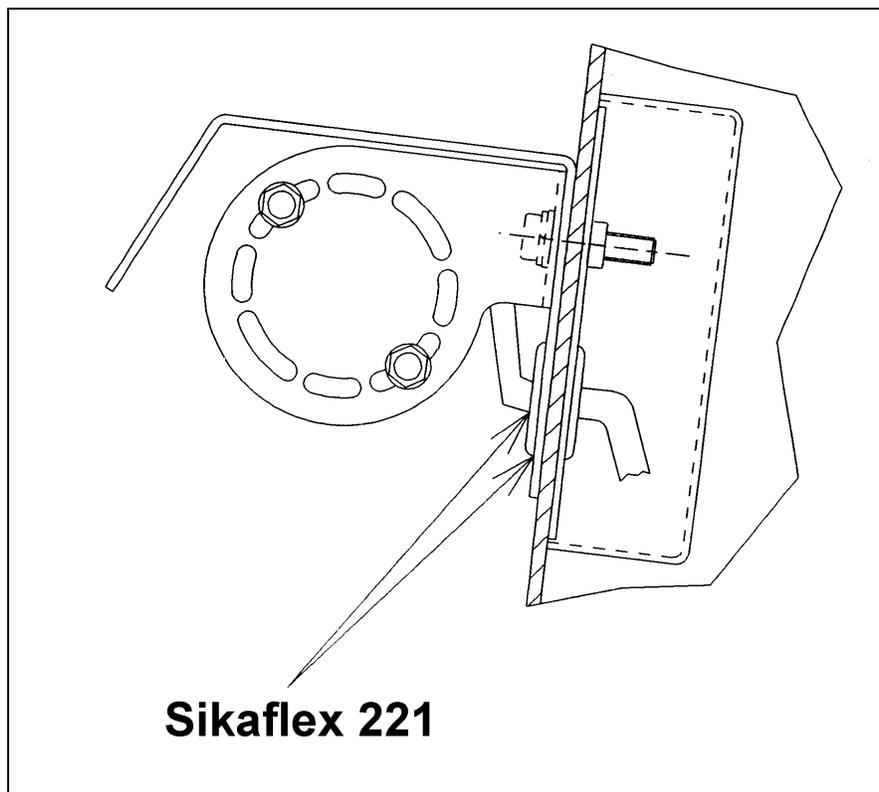
FIGURE 2 : COUPE DU MONTAGE DE L'ENSEMBLE CAMÉRA
