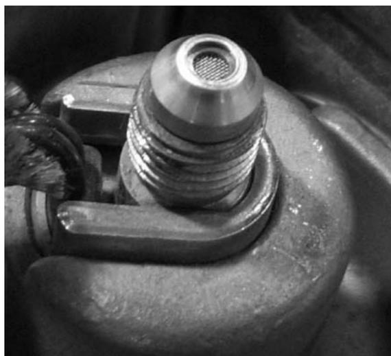
TAMIS MÉTALLIQUE À L'ORIFICE D'ADMISSION DE L'INJECTEUR
