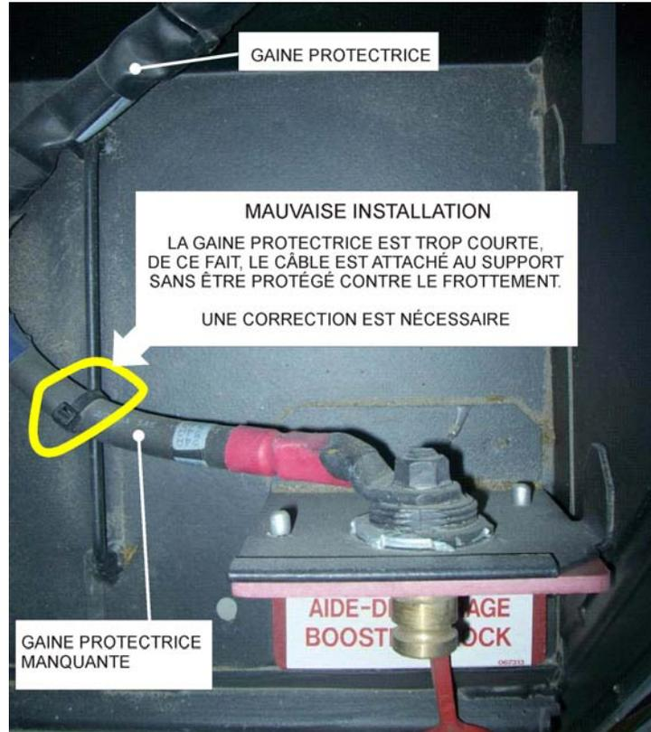
2. Vérifier que la gaine protectrice recouvre le câble jusqu'à environ 2 pouce de la borne. Il est important que le câble soit protégé contre le frottement à son point de fixation, d'où l'utilité de la gaine protectrice (voir la figure).
