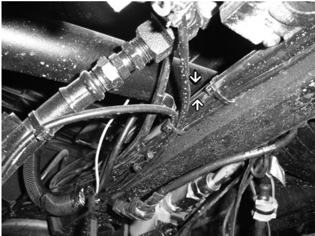
2. Afin de prévenir le contact entre la barre d'accouplement longitudinale et le câble ABS et ATC, vérifier que le câble est attaché sous les tubes pneumatiques et non au-dessus.
