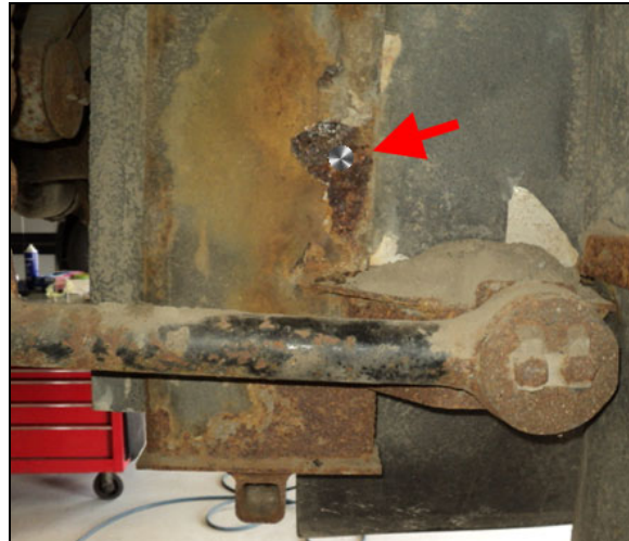
FIGURE 6: ZONE NETTOYÉE SUR LE CHÂSSIS
