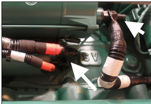
Figure 30: Câbles du démarreur protégés avec le revêtement de protection Color Guard.
