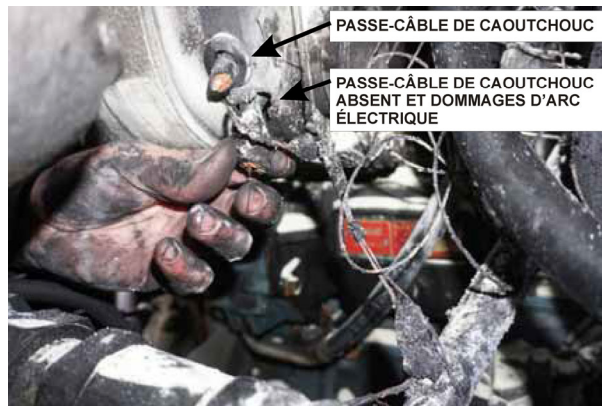
Figure 25 : Incendie du compartiment moteur causé par le frottement du câble de puissance sur le boîtier métallique de l'alternateur Bosch T1. Le passe-câble de caoutchouc n'était pas en place au moment de l'incendie. Des dommages causés par un puissant arc électrique sont visibles.
