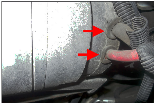
Figure 24: Alternateur Bosch T1 avec les deux passe-câbles (grommet) de caoutchouc requis. Les câbles qui s'insèrent à l'arrière des alternateurs doivent être protégés du bord métallique avec des passe-câbles de caoutchouc.
