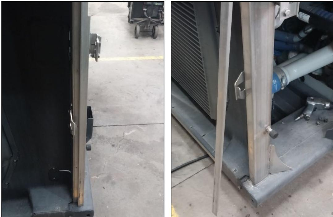
4. Retirer le déflecteur arrière du ventilateur et ses supports métalliques à l'aide d'une douille 10mm (15 vis hexagonales retiennent le déflecteur).
