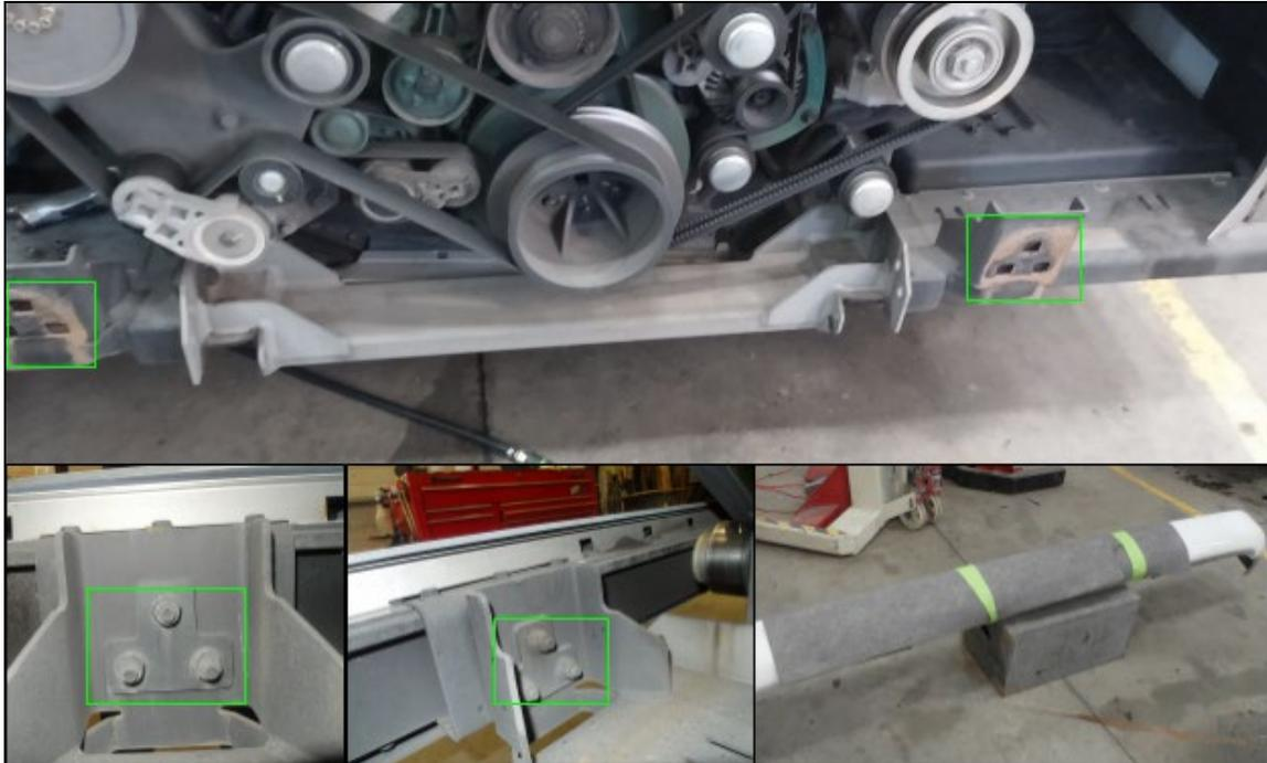
3. Ouvrir la porte moteur gauche et retirer la bordure d'acier inoxydable rivetée au pilier de support arrière gauche (utiliser une perceuse électrique et un foret de diamètre approprié).
