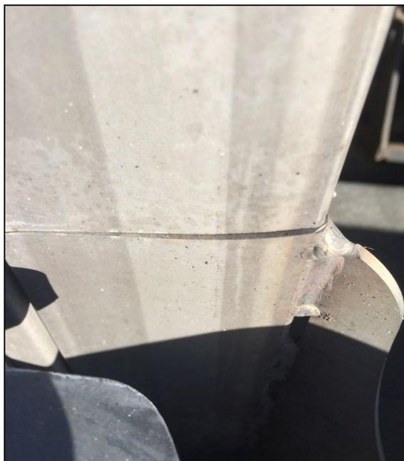
Sur ces véhicules, il est possible d'installer et de souder un renfort de structure à l'intérieur du pilier de support pour réparer la zone endommagée.
