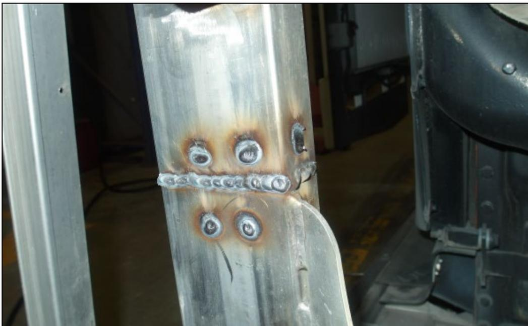
13. Pour des raisons esthétiques, les soudures doivent être meulées et sablées jusqu'à l'obtention d'une surface semi-lisse s'harmonisant avec le fini naturel du pilier de support.
