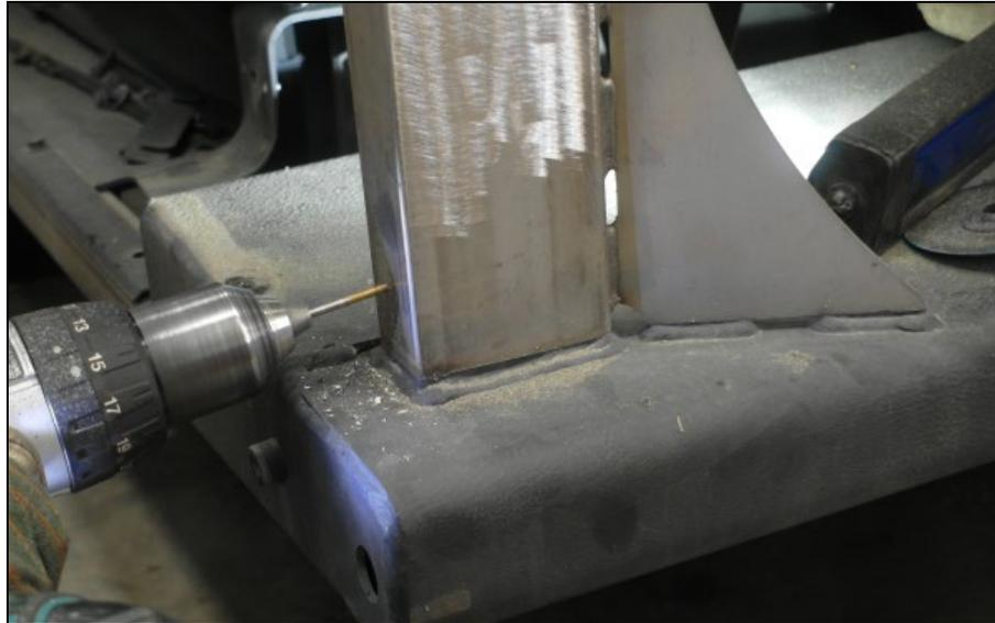
16. Réinstaller le déflecteur de radiateur et ces supports métalliques; S'assurer que le trou inférieur du pilier de support et celui du renfort coincident, percer au besoin (ne pas oublier d'installer le bouton de loquet sur la tige d'ouverture de la porte du catalyseur).
