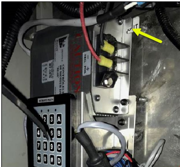
FIGURE 9 : GEN1 FIXER L'EXTRÉMITÉ NON SUPPORTÉE
