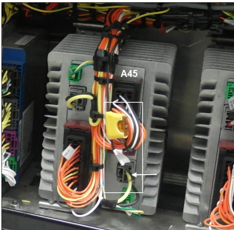
BRANCHEMENT DU MODULE D'INTERFACE AU MODULE A45
