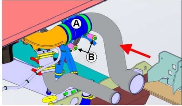
**FIGURE 106: CONNECTION AT THE TURBO OUTLET ELBOW**
