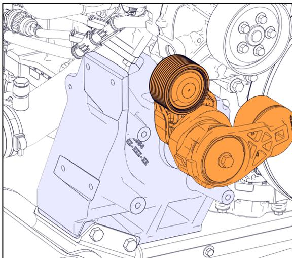
FIGURE 48: LAISSER L'ENSEMBLE TENDEUR / GALET TEL QUEL.
