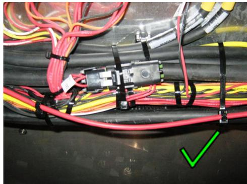
Le LTD doit cheminer à l'écart des arrêtes, de vis et autres composants
