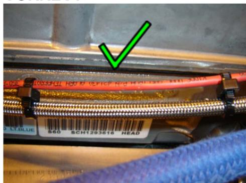
Le LTD doit être fixé à l'aide d'attache double. Les attaches de doivent pas être espacées de plus de 4 pouces (100mm) maximum
