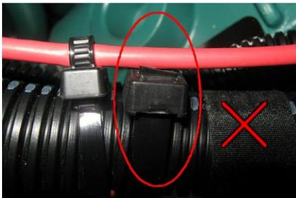
LTD en contact avec une attache de nylon coupée
