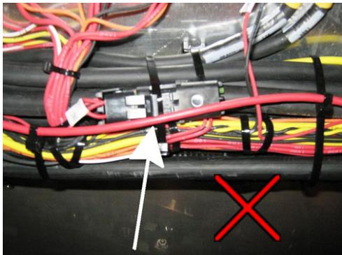
Contacts possibles ou frottement contre des arrêtes, des vis, etc.
