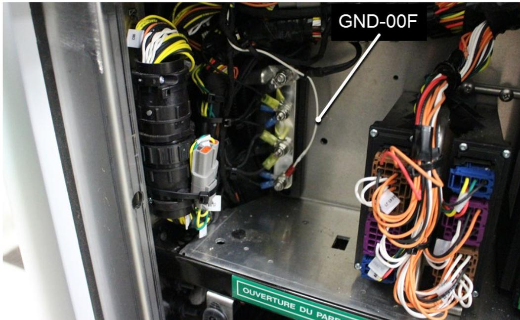
FIGURE 27: ELECTRONIC GROUND STUD
