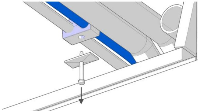
**FIGURE 8 : OTHER TYPICAL SPLIT BLOCKS AT THE CEILING OF THE BAGGAGE COMPARTMENTS (9 LOCATIONS)**
