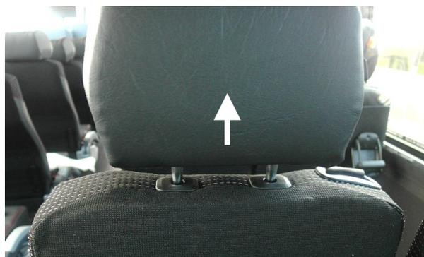
3. Plier la partie centrale du séparateur vers l'intérieur et fixer les 2 crochets aux 2 supports de l'appui-tête.
