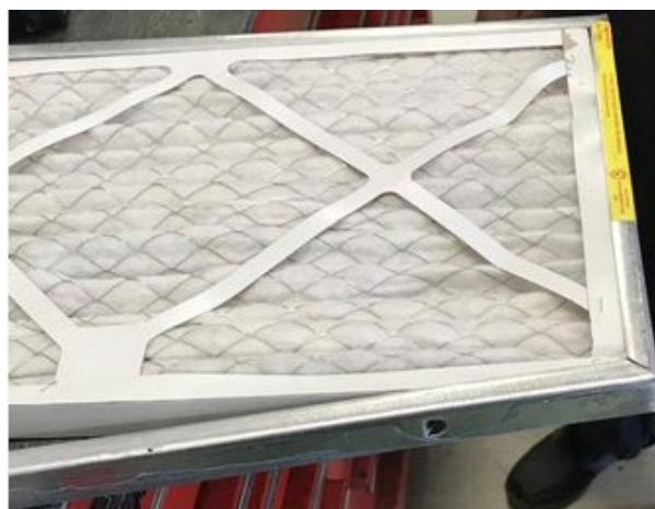
8. Réassembler le cadre en métal (réinsérer et replier la languette de fixation).
