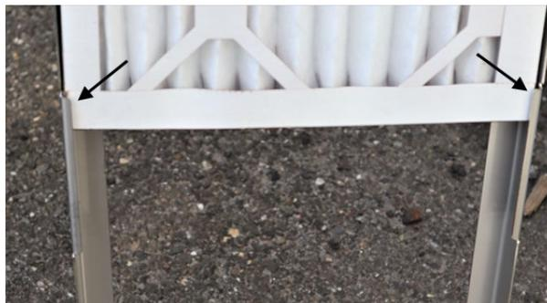
2. S'assurer que la flèche de direction du flux d'air de l'élément filtrant correspond à la flèche de flux du cadre métallique.
