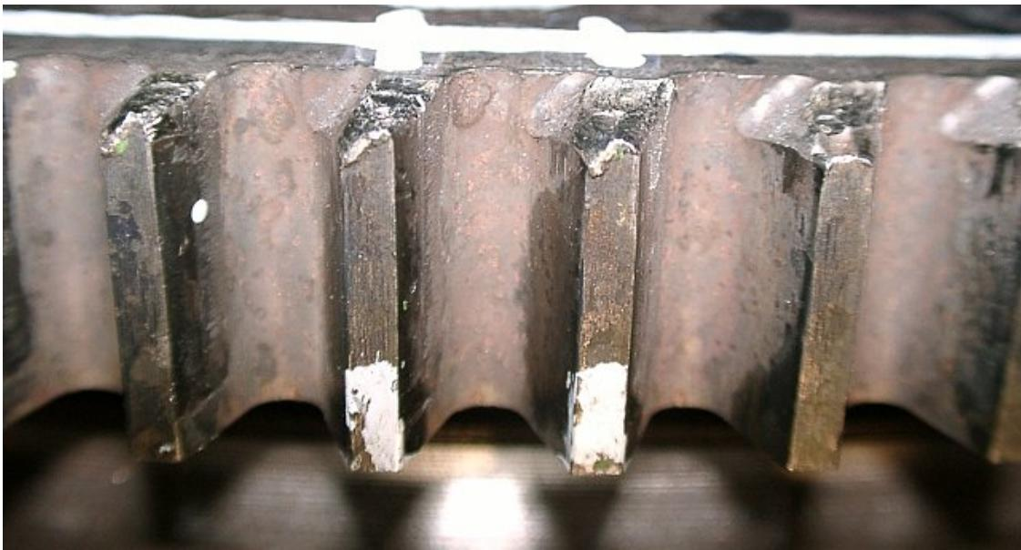
Se référer aux photos ci-dessus et remplacer la couronne dentée dont les niveaux d'usure sont semblables à ceux-ci. Voir la page suivante pour la marche à suivre appropriée pour les opérations de mesure.
