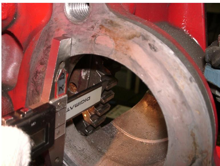
Dimension entre la surface de montage et la partie endommagée de la couronne dentée.
