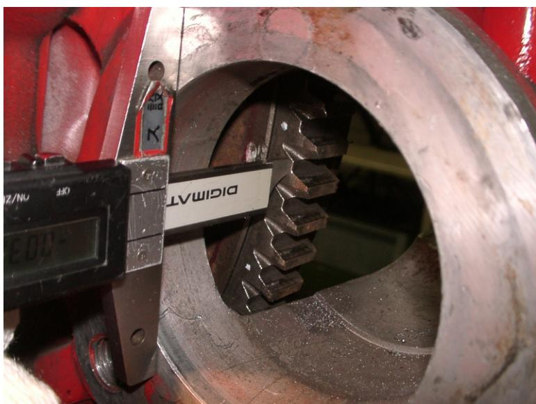
Dimension entre la surface de montage et la surface extérieure de la couronne dentée
