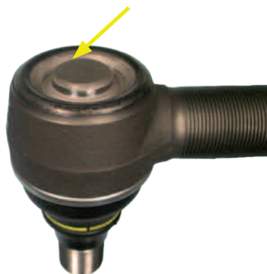
Podzespół 33 - nisko położony pokrywa, niewielka wysokość konstrukcyjna sprężynowanie maksymalnie 0,5 mm
