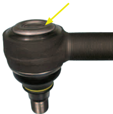
Sous-ensemble 31 - chapeau bombé compression maximale 2 mm
