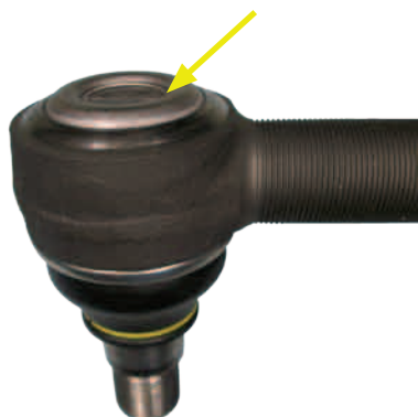
Podzespół 31 - kołpak sklepiony sprężynowanie maksymalnie 2 mm
