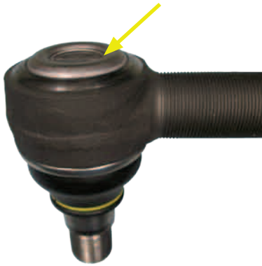
Baugruppe 31 - gewölbte Kappe maximal 2 mm Einfederung
