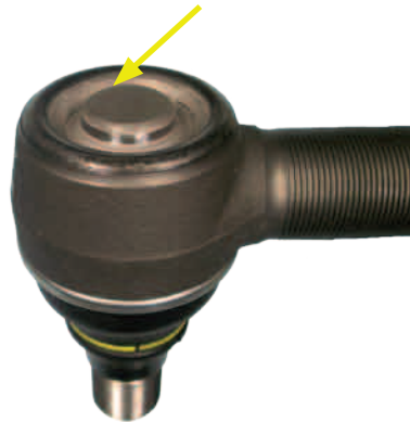
Baugruppe 33 - tiefer Deckel, niedrige Bauhöhe maximal 0,5 mm Einfederung
