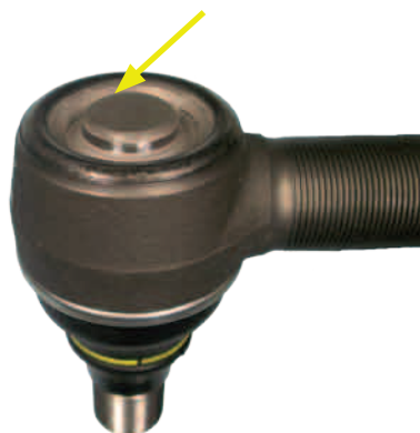
Módulo 33 - tampa mais profunda, altura total menor Máximo 0,5 mm para dentro
