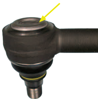
Узел 31 - выпуклая крышка, вдавливание максимум на 2 мм
