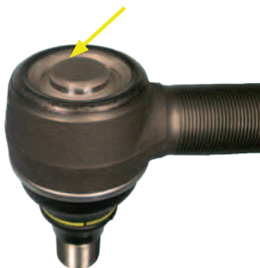
Sous-ensemble 33 - couvercle profond, faible hauteur de construction, compression maximale 0,5 mm
